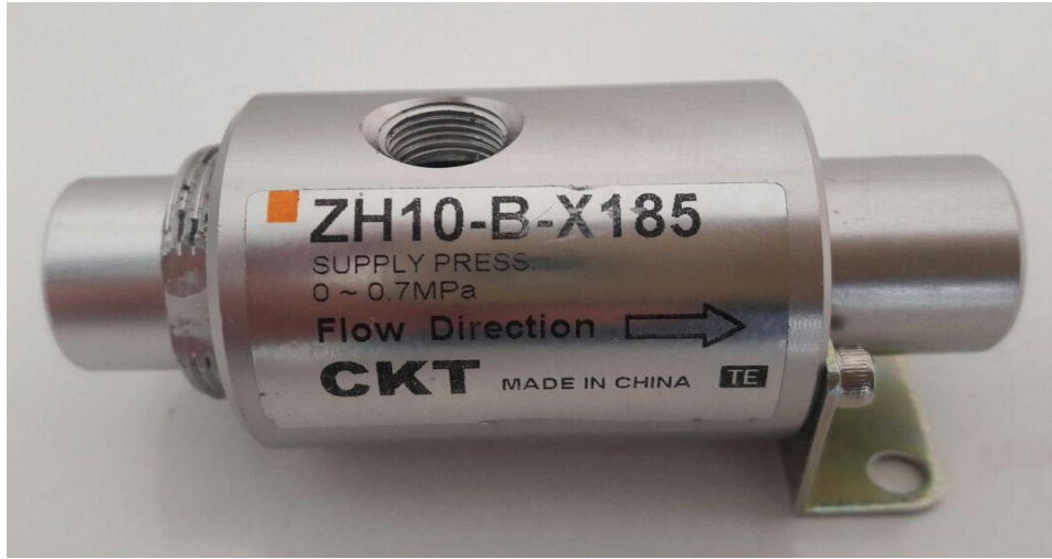
Şekil 3.5. Deneysel çalışmada kullanılan hava yükseltici (ZHB10-B-X185 modeli)
