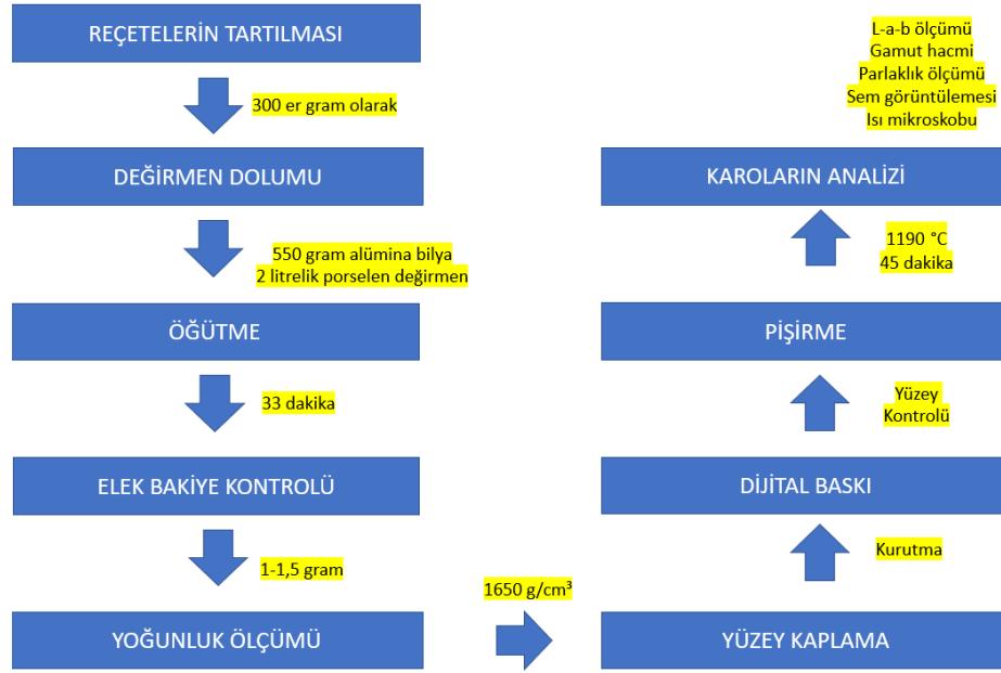
Şekil 4.1. Deney karolarının hazırlanması akım şeması
