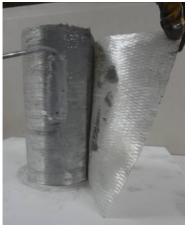
a. GFRP ile beton güçlendirmesi
