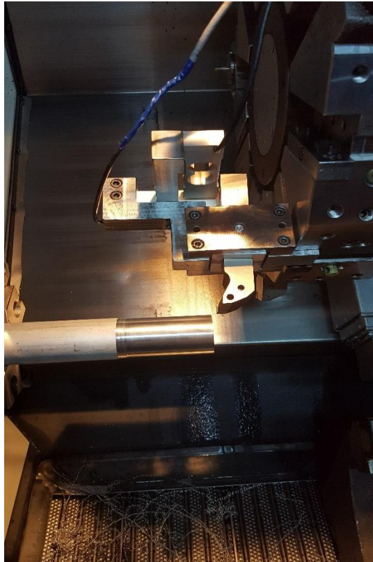
Şekil 6.5. Tornalamada Kullanılacak Dinamometrenin Deney Anı
