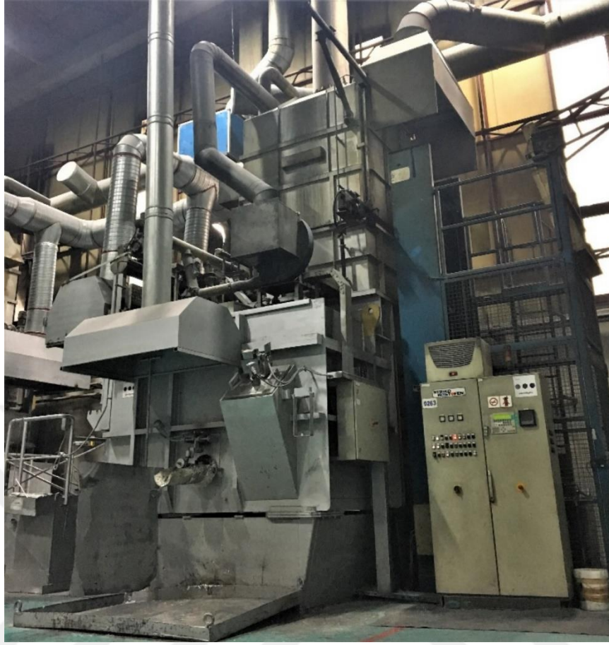
Şekil 4.4. StrikoWestofen ergitme fırını.
