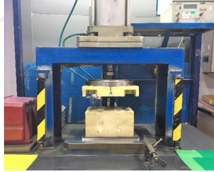
Şekil 5.16. E1 parçası sızdırmazlık test sistemi.
