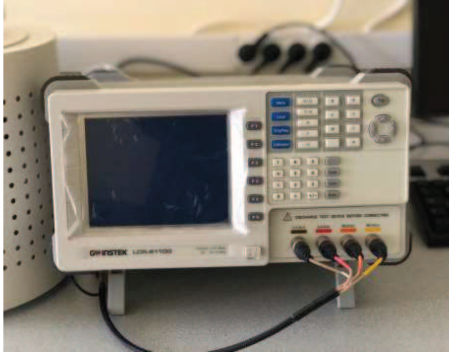
Şekil 3.4. Dielektrik ve iletkenlik ölçümleri için kullanılan LCR-metre
