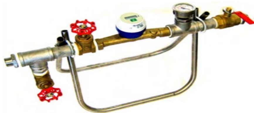
Şekil 6.7. Kaya birimleri içine sızan suyun miktarını ölçmede kullanılan su sayacı ve su basıncını gösteren manometre
