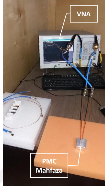
Şekil 4.31. PMC mahfaza prototipi elektriksel testleri
