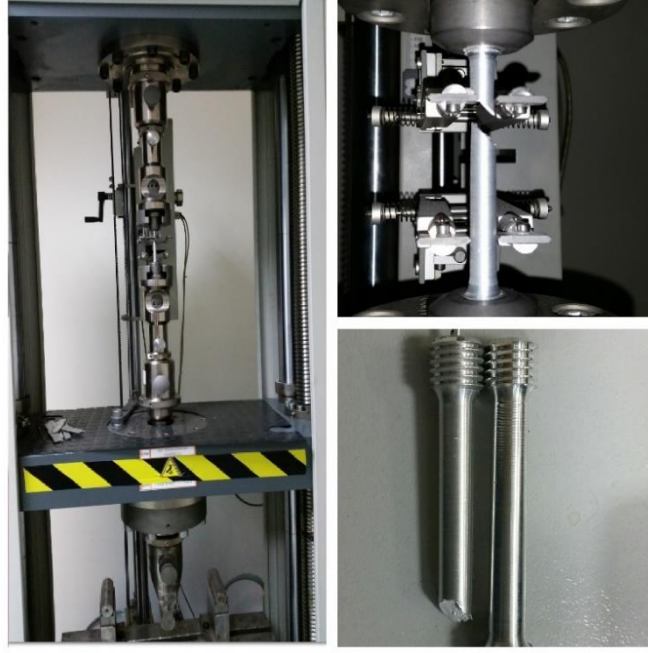
Şekil 4.13. Zwick Roell Z250® Çekme Test Cihazı ve Çekme Testi Yapılmış Numuneler
