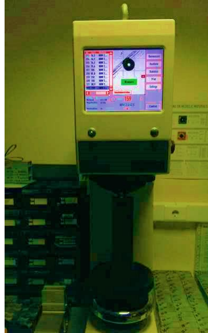
Şekil 4.14. Sertlik Ölçüm Cihazı
