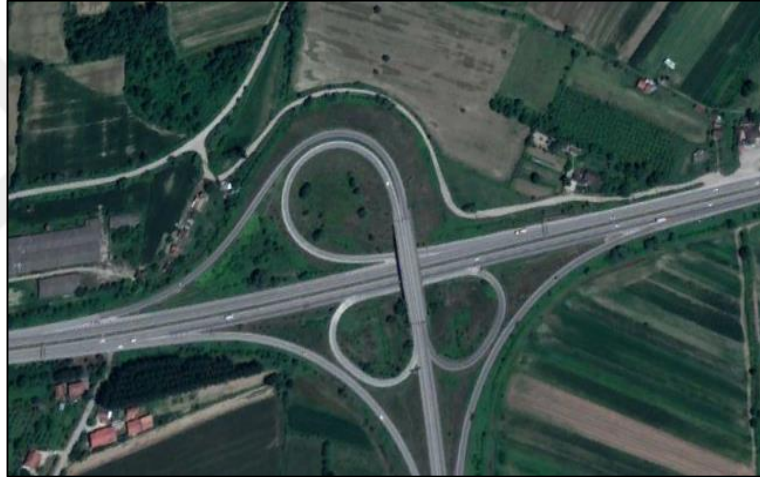
Şekil 2.19. Üç çeyrek yonca kavşak örneği [9]
