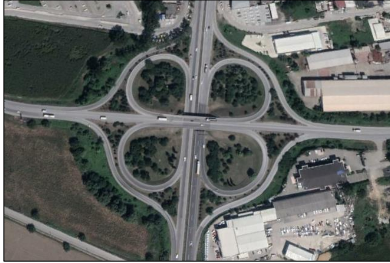
Şekil 2.18. Toplayıcı/dağıtıcı yollu yonca kavşak örneği [9]
