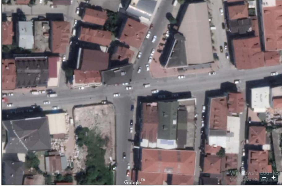
Şekil 2.4. Kanalize edilmemiş 4 kollu kavşak [9]
