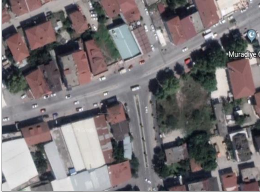
Şekil 2.3. Kanalize edilmemiş T kavşak örneği [9]
