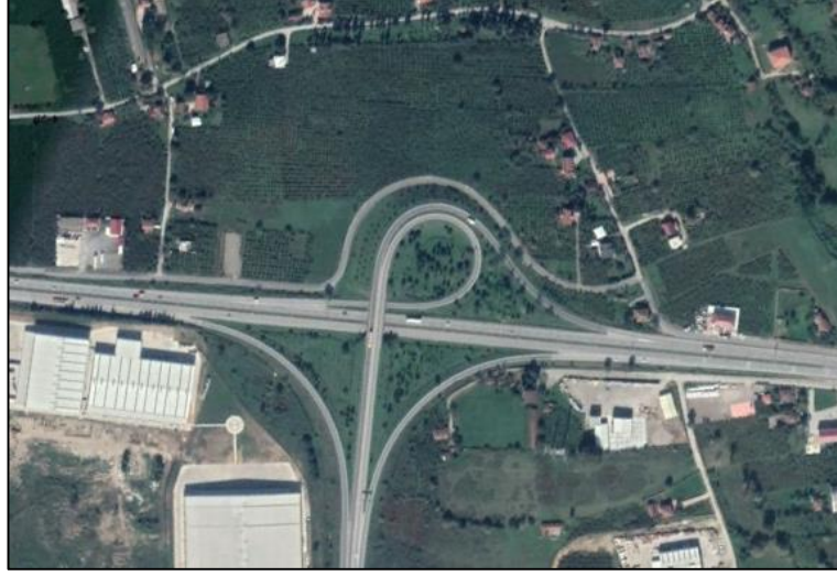
Şekil 2.13. Trompet kavşak örneği [9]
