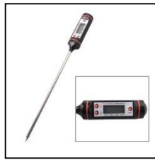
Şekil 2.11. Windrow Kompost Yığını Sıcaklık Ölçüm Probu Örneği [21]
