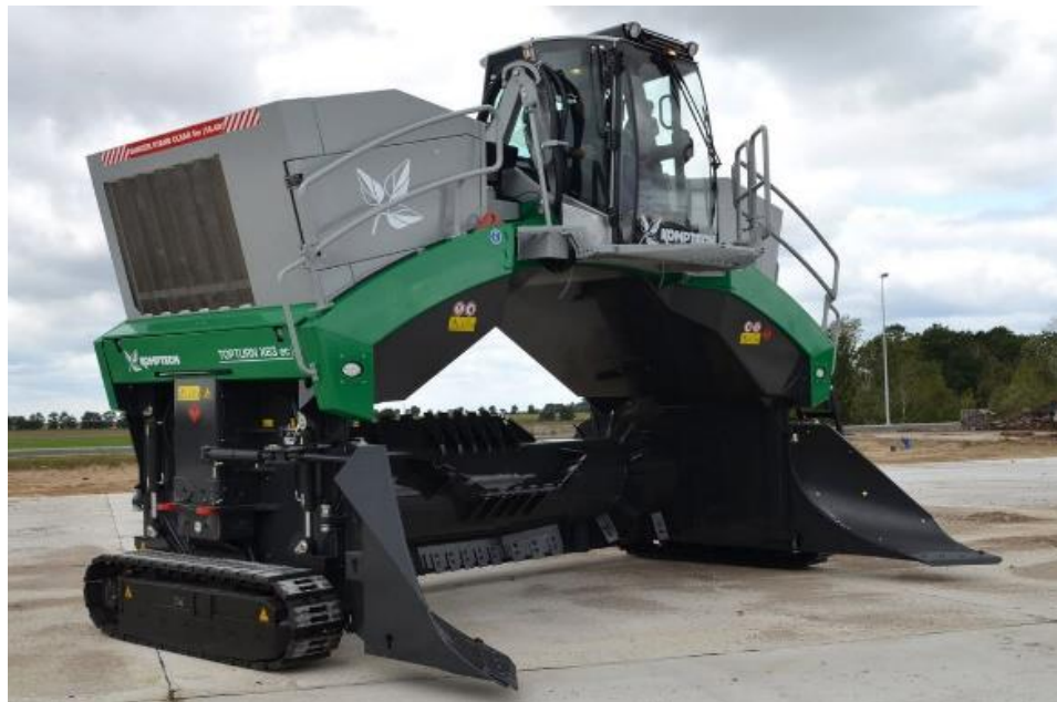
Şekil 1.4. Kendi Yürür Tip Karıştırma Ekipmanı [14]
