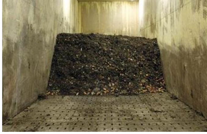
Şekil 2.13. Yığın Havalandırma Kanalları [23]
