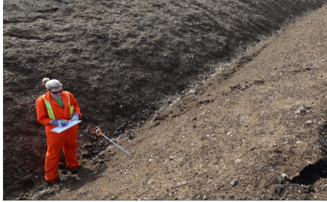
Şekil 2.10. Windrow Kompost Yığını Sıcaklık Ölçümü [20]
