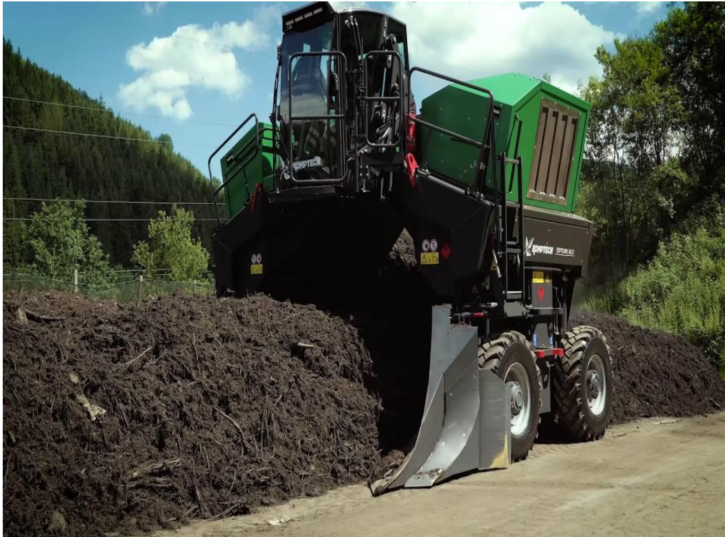
Şekil 2.6. Kendi Yürür Tip Kompost Karıştırıcı [17]
