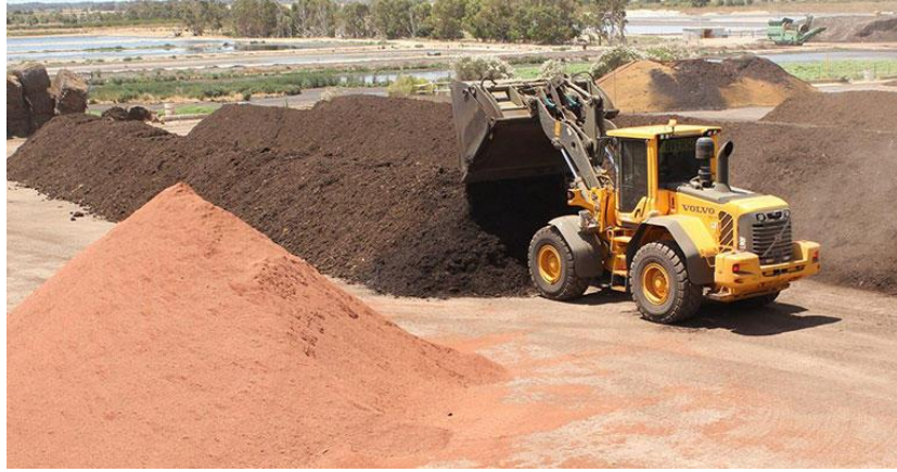
Şekil 2.8. Windrow Kompost Yığın Oluşurma – 1 [18]
