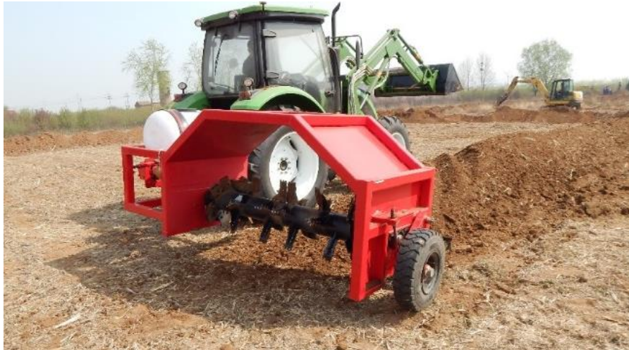
Şekil 1.3. Traktör Tahrikli Arıştırma Ekipmanı [14]
