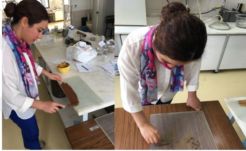
Şekil 4.8. Plastik limit deneylerinin yapılışı
