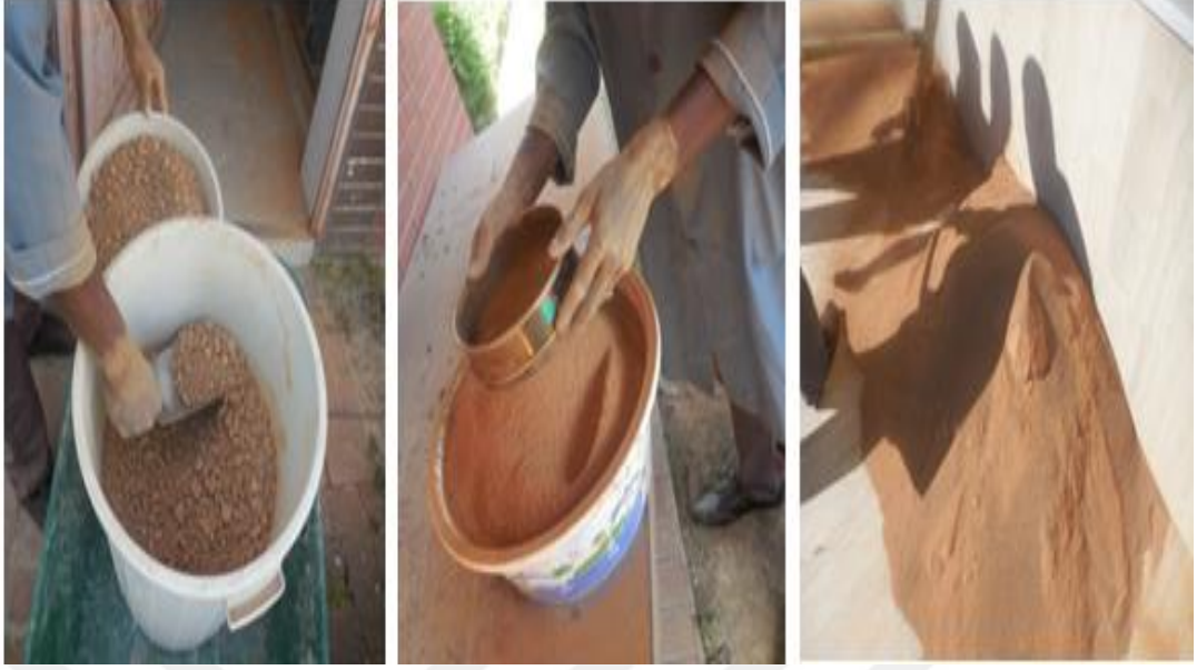
Şekil 4.10. Kil numunesinin elenerek deney için hazırlanması
