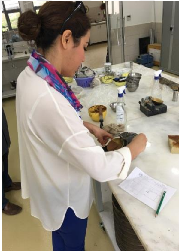
Şekil 4.4. Casagrande yöntemi ile likit limit deneylerinin yapılışı
