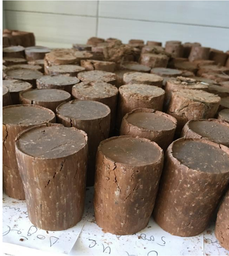
Şekil 5.5. UC Deneyleri sonunda numunelerin kayma yüzeyleri
