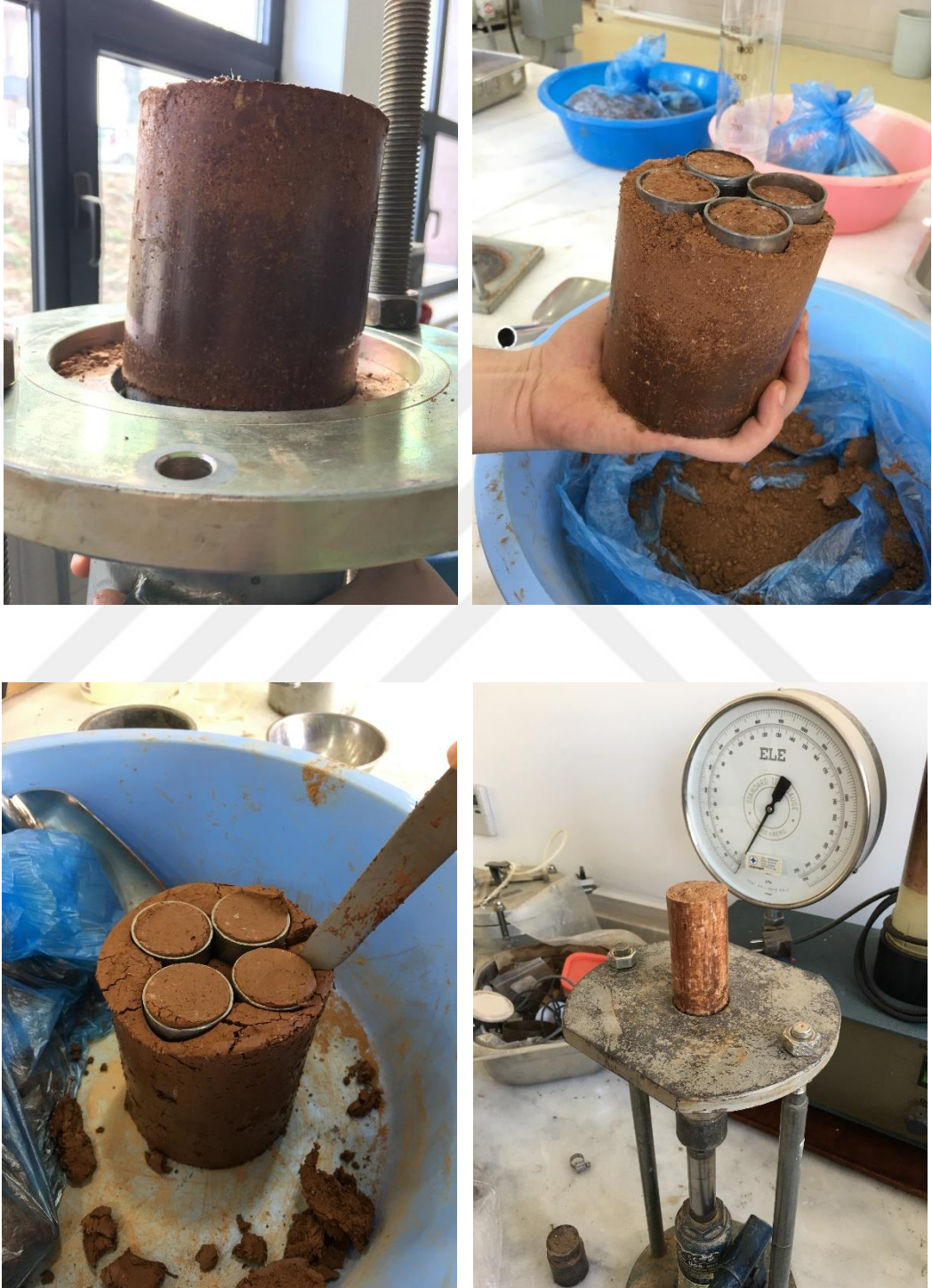
Şekil 4.13. Serbest basma deneyinin aşamaları
