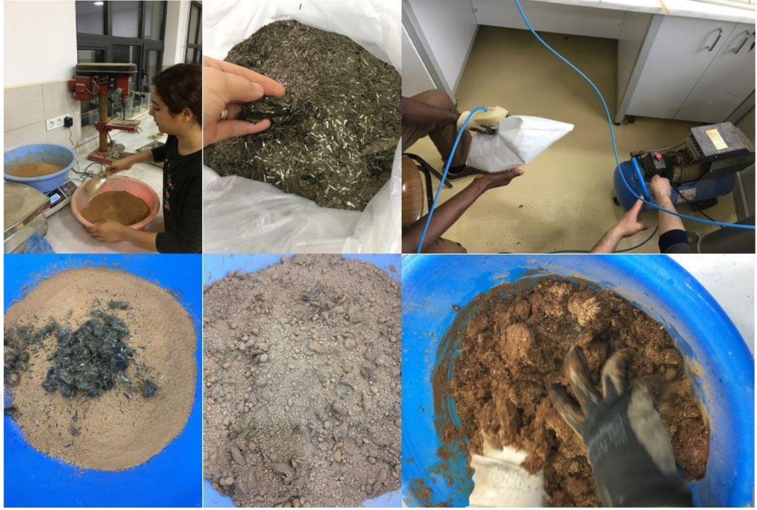
Şekil 4.11. Bazalt fiberin zemine karıştırılması
