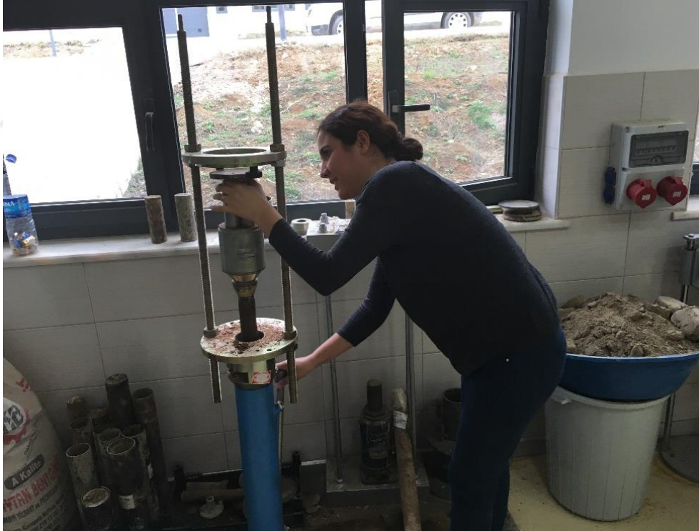
Şekil 4.12. Serbest basma deneyinin aşamaları
