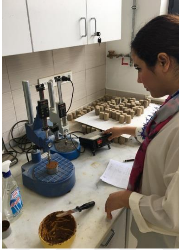
Şekil 4.5. Koni düşürme yöntemi ile likit limit deneylerinin yapılışı
