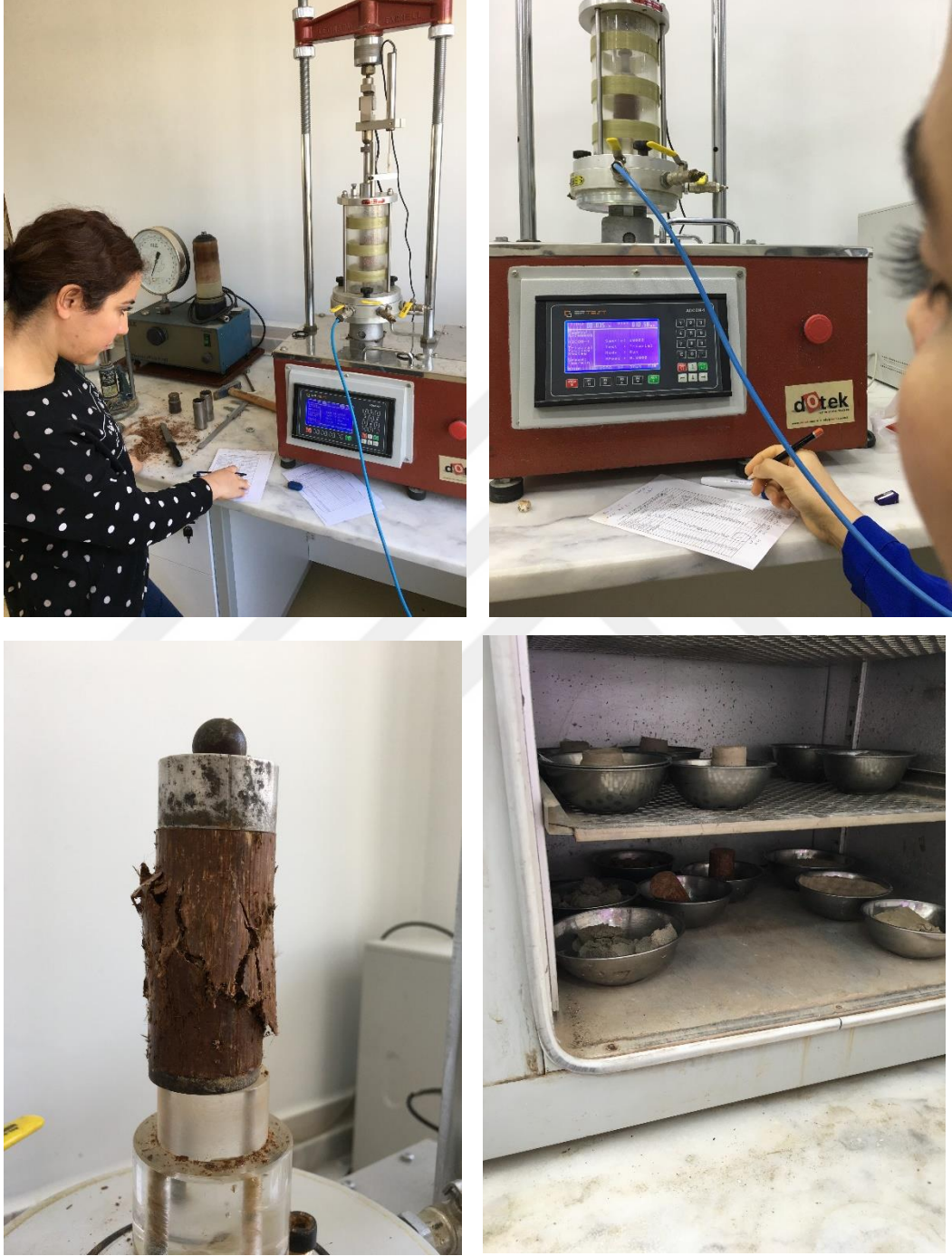
Şekil 4.14. Serbest basma deneyinin aşamaları
