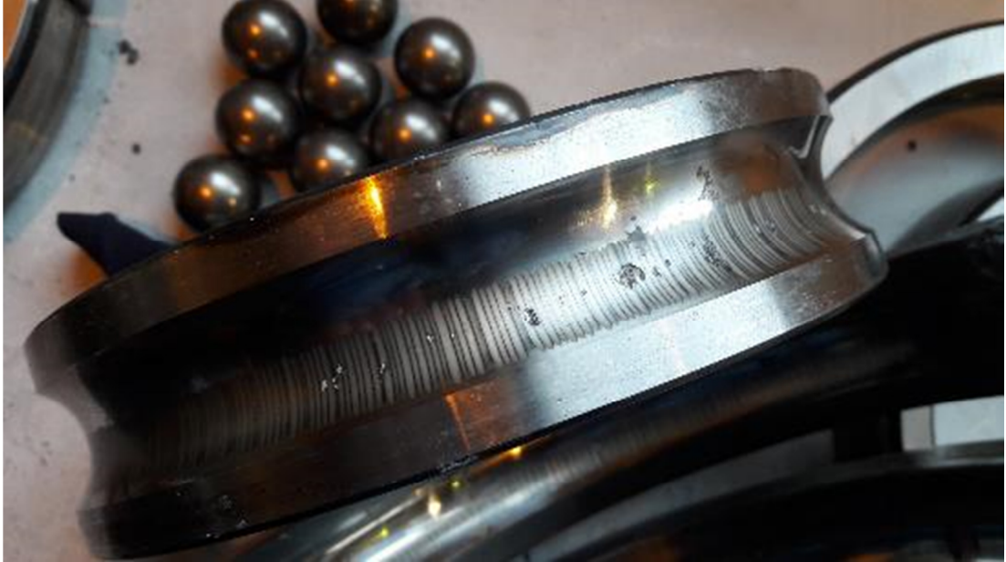
Őekil 4.1. PA Fan elektrik akım kaynaklı yivlenmiř (6232) rulman arızası (electrical fluting)
