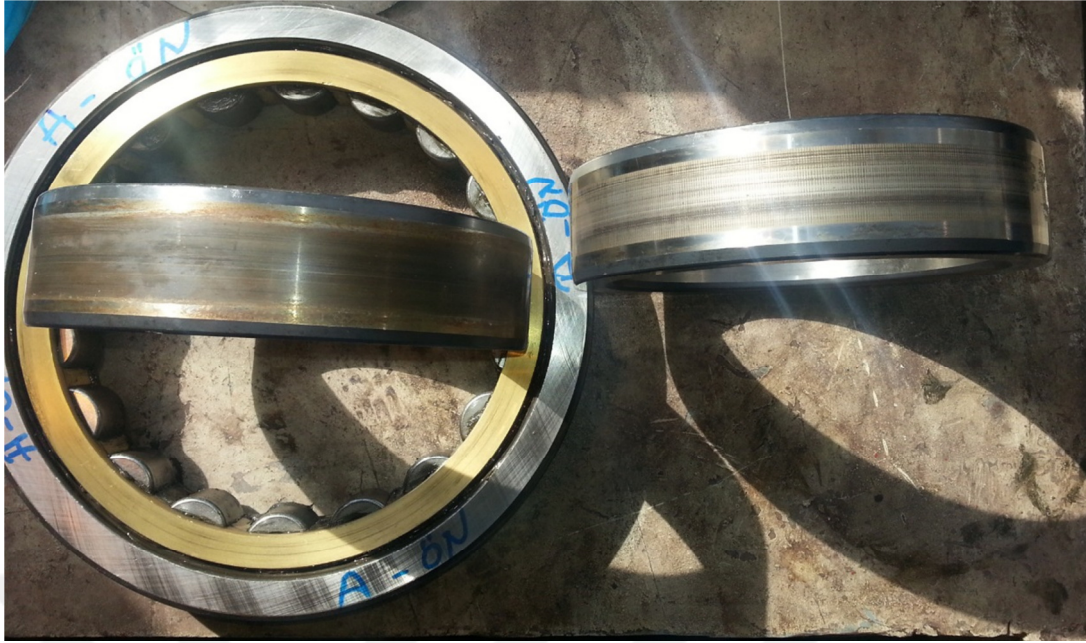
Şekil 4.2. PA Fan elektrik akım kaynaklı yivlenmiş (NU232) rulman arızası (electrical fluting)
