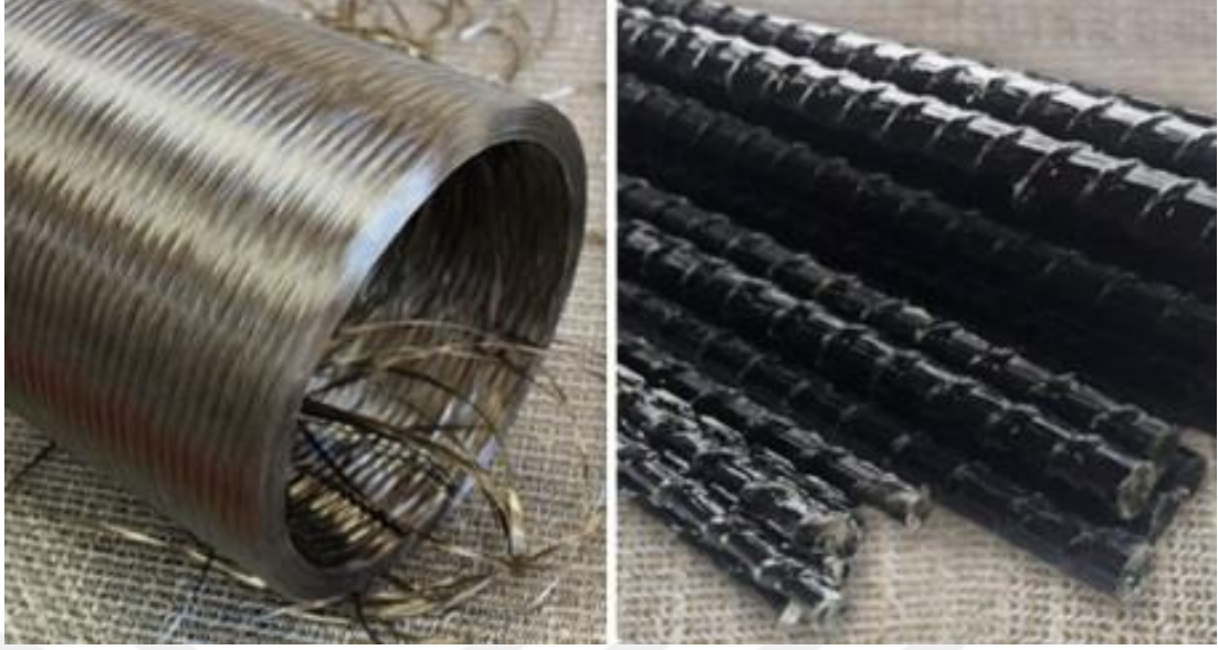
Şekil 3.3. Bazalt donatı çubukları (Bazalt donatı, 2019).
