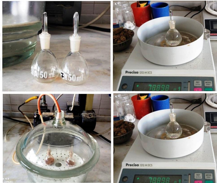
Şekil 4.8. Özgül ağırlık deneyi aşamaları
