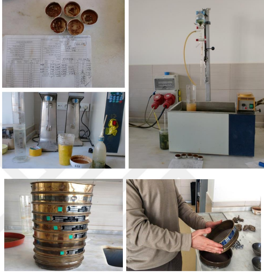
Şekil 4.9. Dane çapı dağılımının bulunması, hidrometre ve elek analizi deneyleri
