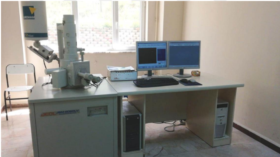
Şekil 4.16. Sakarya Üniversitesi Metalurji ve Malzeme Mühendisliği Bölümü Laboratuvarındaki SEM analizi cihazı
