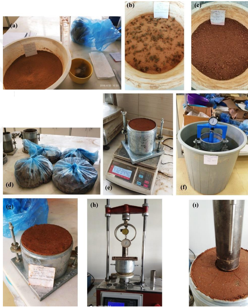
Şekil 4.14. (a) Kil, bazalt fiber, 600 ml su, (b) kil zemine bazalt fiber ve su ilavesi, (c) rastgele karıştırılan bazalt fiberin son hali, (d) poşetleme, (e) sıkıştırma sonucu tartım, (f) 96 saat ıslatma, (g) ıslatma sonu şişme görünümü, (h) CBR okumaları, (i) CBR deney bitimi numune görünüşü
