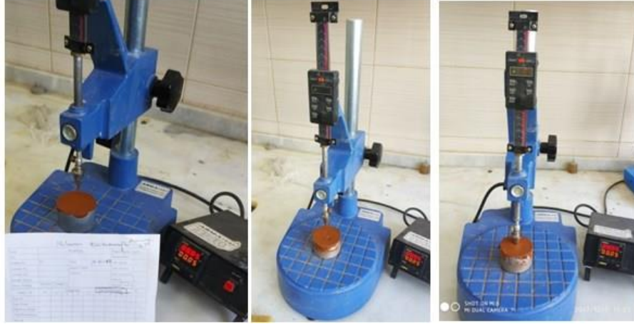
Şekil 4.4. Casagrande ve koni düşürme yöntemi ile likit limitin bulunması
