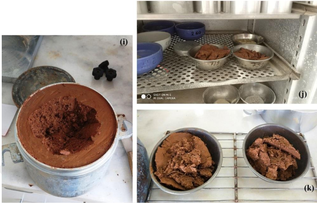
Şekil 4.15. (i) CBR deney bitimi numune alımı, (j) alt ve üst bölgeden alınan numuneler, (k) numunelerin etüve konması
