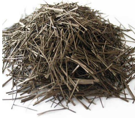
Şekil 3.1. Kıyılmış bazalt fiberler (Bazalt, 2019).
