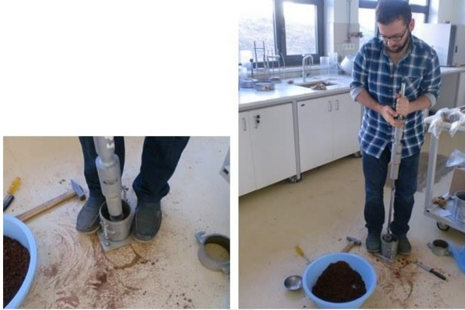
Şekil 4.12. Modifiye proktor deneyi yapılışı
