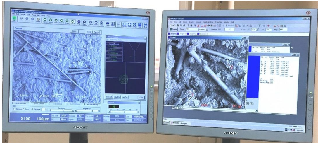
Şekil 5.2. SEM analizi: kil zeminin mikro yapısı
