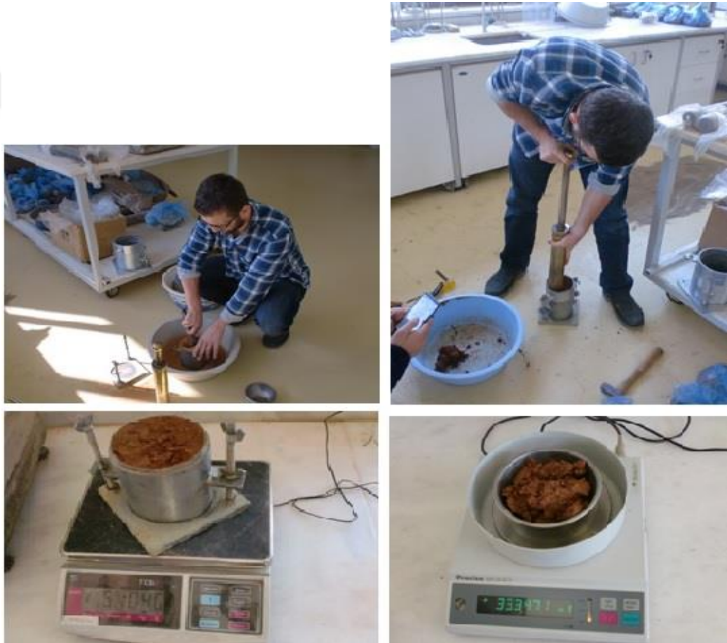
Şekil 4.10. Standart kompaksiyon deneyi
