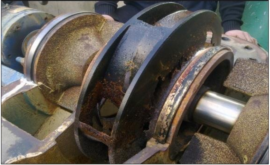
Şekil 3.13. Kavitasyonlu çalışmaya maruz kalmış santrifüj pompa çarkı [39]
