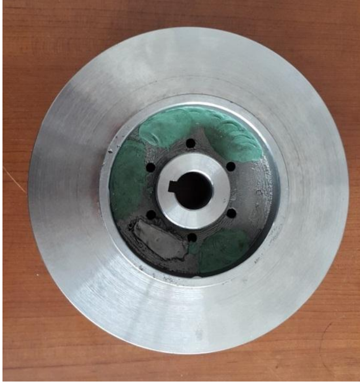
Şekil 6.5. İmalatı ve bitirme işlemleri yapılmış teste hazır çark
