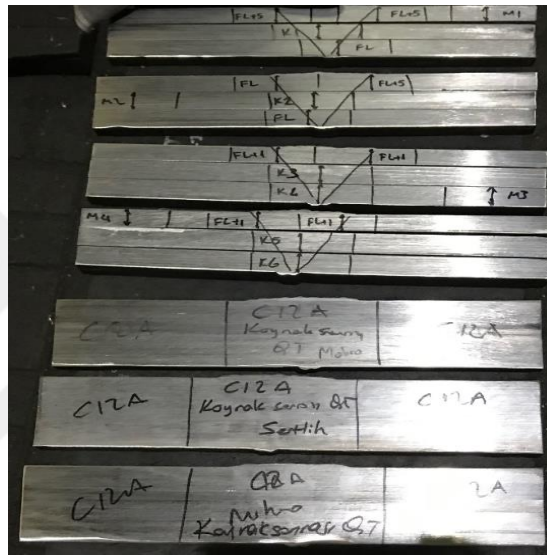
Şekil 5.9. Kaynak uygulanan plakalardan çıkarılan numunelerin konumları
