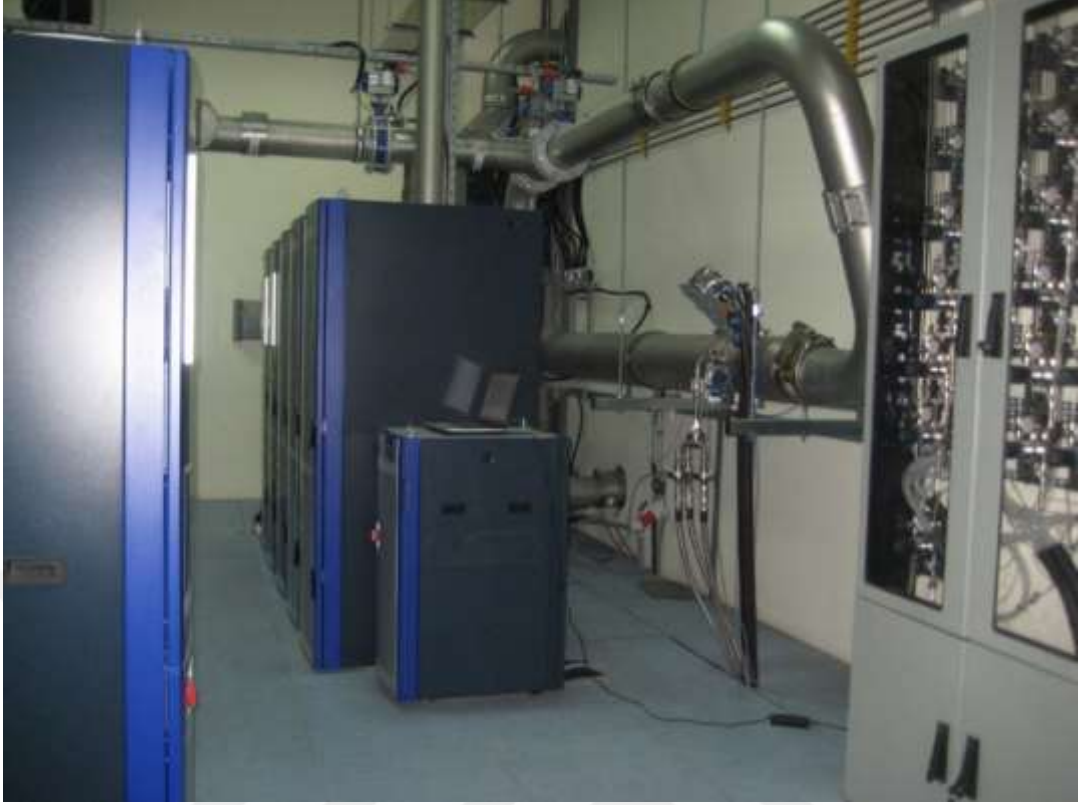
Şekil 4.3. Motor ve Şasi Dinamometresi İçin Emisyon Ölçüm Cihazlarının AVL AMA-i60 Resmi
