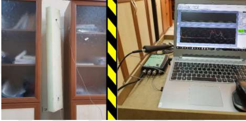
Şekil 4.22. Deneysel modal analiz deney düzeneği – Serbest-serbest.
