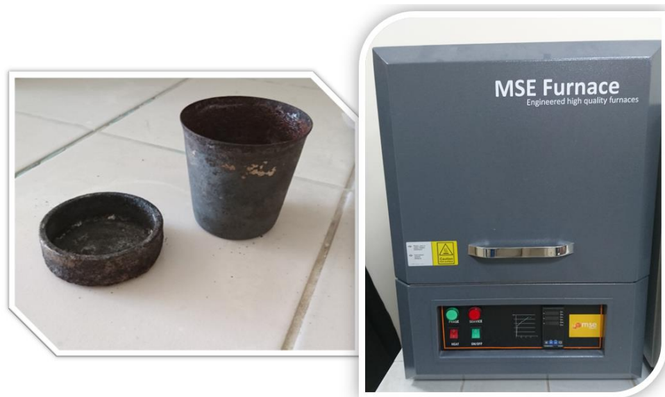
Şekil 7.2. T6 ısıtıl işleminin gerçekleştirildiği pota ve ısıtıl işlem fırını.
