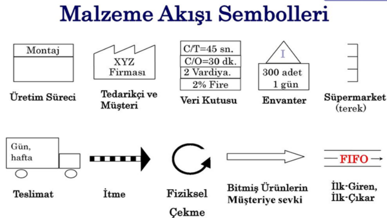
Şekil 3.1. Malzeme Akış Sembolleri
