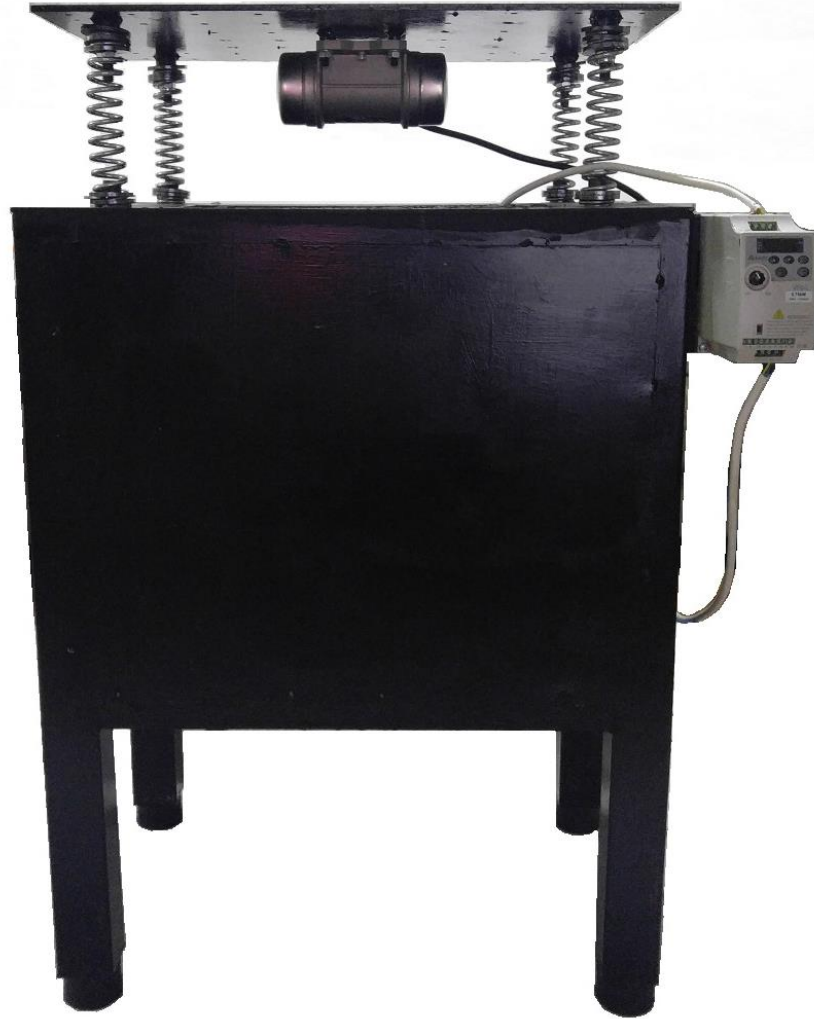
Şekil 3.8. Tez çalışması kapsamında geliştirilen titreşimli kalıplama makinesi.
