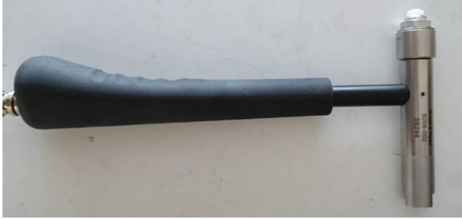
Şekil 4.10. Brüel&Kjaer Type 8206-002 model darbe çekici
