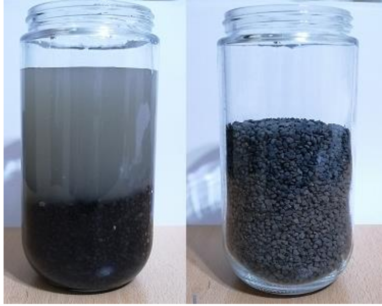
Şekil 3.1. Yıkama işlemi öncesinde ve sonrasında bazalt granüller
