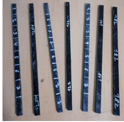
Şekil 4.8. Titreşim sönümlenme testi numune örnekleri
