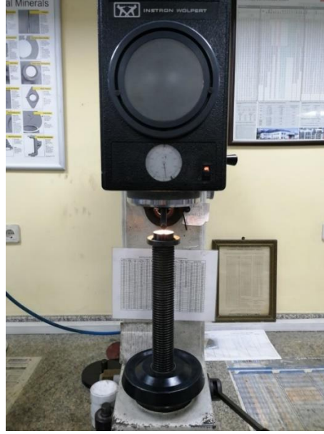
Şekil 4.22. Sertlik test cihazı ve test numunesi
