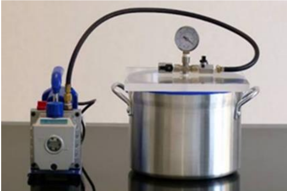
Şekil 3.5. Vakum pompası ve baloncuk arındırma haznesi
