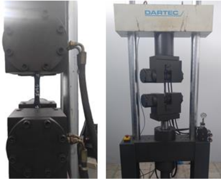
Şekil 4.1. Çekme cihazı ve çekme testi numunesi
