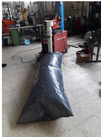
Şekil 4.6. Debi hesabı için doldurma
