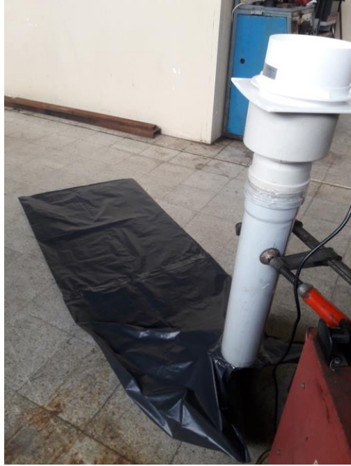
Şekil 4.7. Debi hesabı için hacmin boşaltılması
