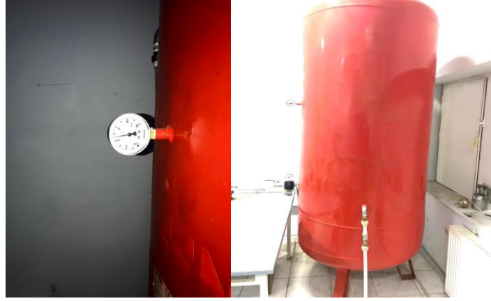
Şekil 4.9. Basınç göstergeli basınçlı hava deposu
