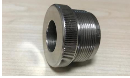
Şekil 4.3. Soğuk kanal kapağı
