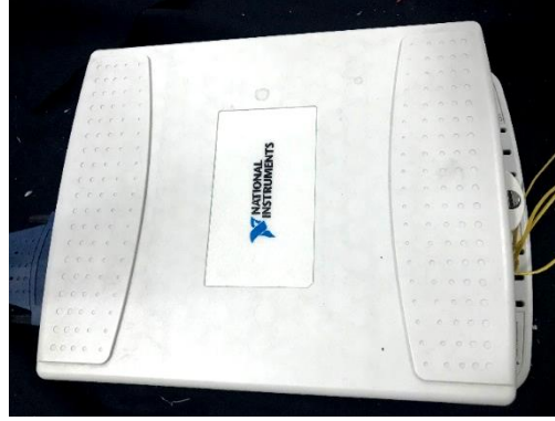
Şekil 4.12. Veri Toplama sistemine ait termal çift bağlantı ekipmanı
