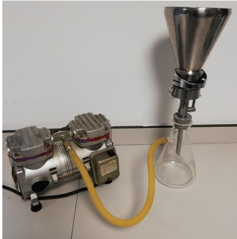
Şekil 4.18. Test sıvısının filtreden geçirme işleminin yapıldığı düzeneğin görüntüsü
