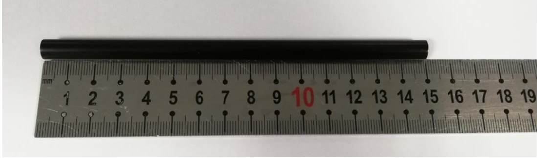
Şekil 4.8. Çekme deneyinde kullanılan örnek bir numune görüntüsü
