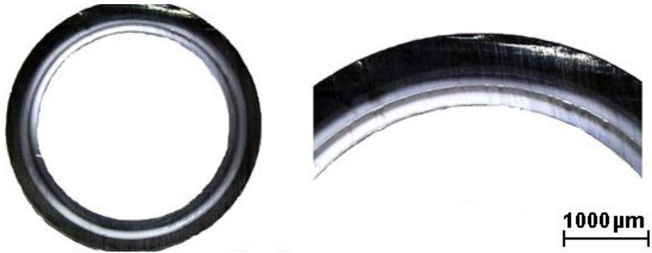
Şekil 4.4. 5 katlı PA boruya ait optik mikroskop görüntüsü
