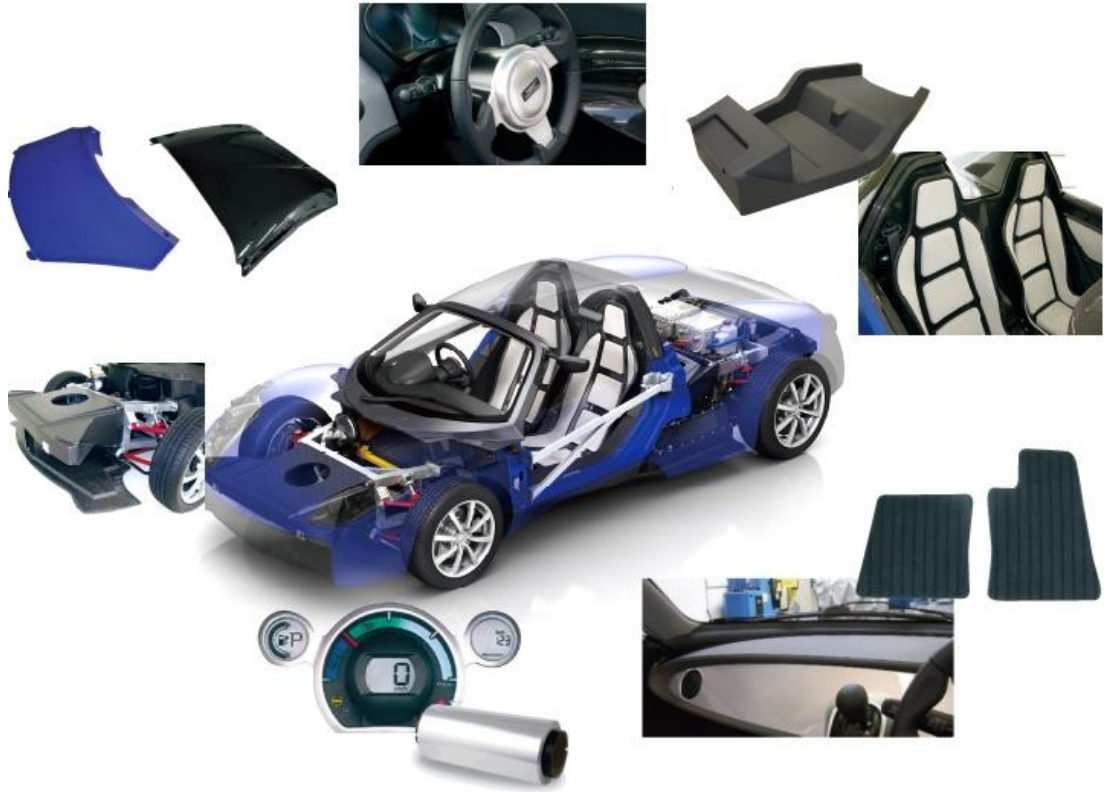
Şekil 3.1. Otomotiv endüstrisinde kullanılan kompozit malzeme örnekleri [37]
