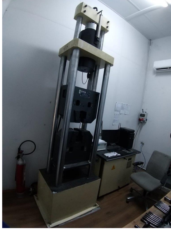
Şekil 5.22. Alşa marka 30 ton'luk PLC-Hidrolik kontrollü çekme cihazı
