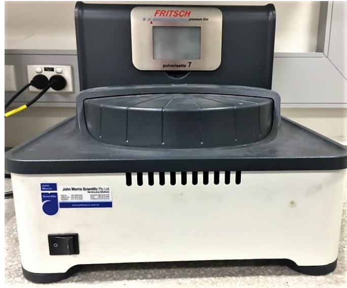
Şekil 4.4. Bilyalı değirmen (Fritsch Pulverisette 7).
