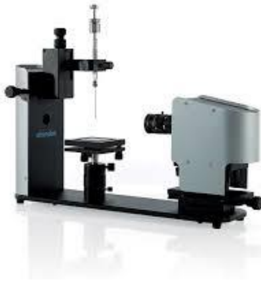
Şekil 2.10. Temas açısı ölçüm cihazı.
