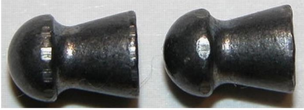
Şekil 2.9. Konvansiyonel ve poligonal namludan çıkan saçma parçalarının görüntüleri
