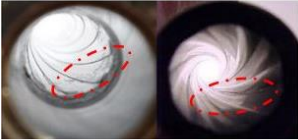
Şekil 2.8. Konvansiyonel ve poligonal namlularındaki barut artığı görünümü
