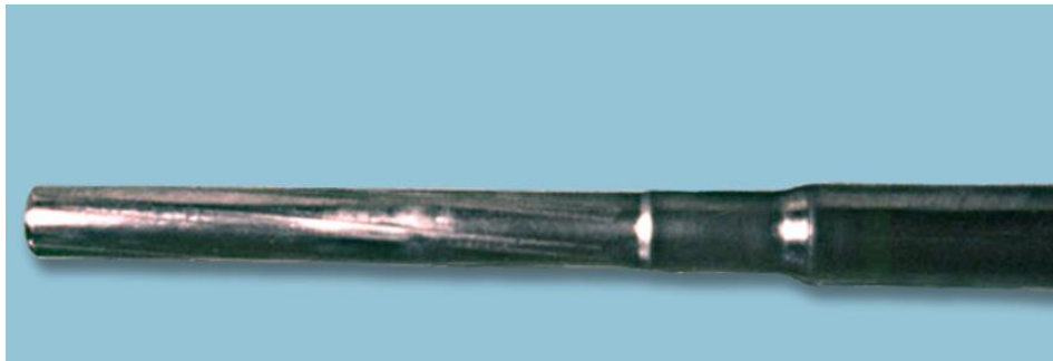
Şekil 3.4. Namluda istenen yiv-set yönünün negatifi yönde hazırlanmış mandrel
