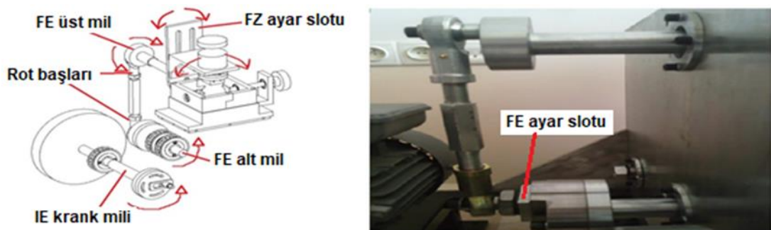
Şekil 4.3. Fleksiyon-Ekstansiyon (FE) mekanizması a) Tasarımı b) İmalatı
