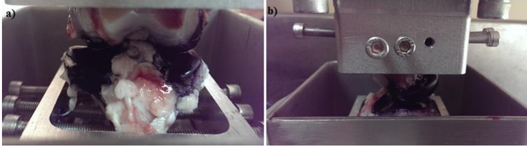
Şekil 5.9. a) Kuzu diz eklemine kalıplara sabitlenmesi b) Kuzu diz eklemine simülatöre bağlanması
