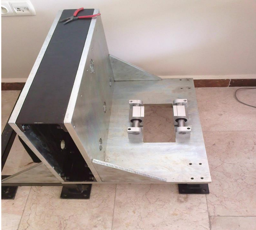
Şekil 4.6. Makine şasisinin montajı
