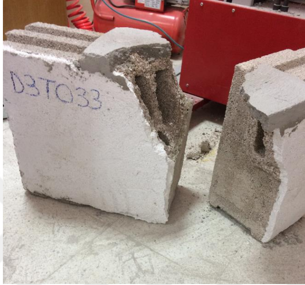
Şekil 3.54. D3T03-3 kodlu numunenin deney sonrasındaki durumu
