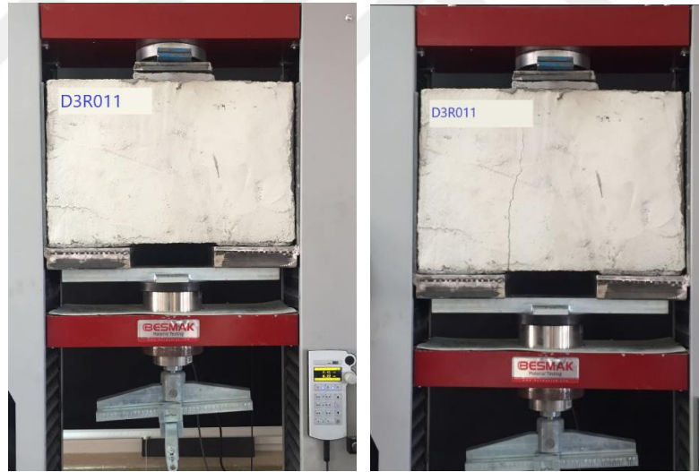
Şekil 3.27. D3R01-1 kodlu numunenin deney öncesi ve sonrasındaki durumu
