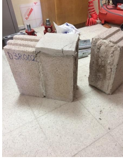
Şekil 3.22. D3R00-2 kodlu numunenin deney sonrasındaki görünümü
