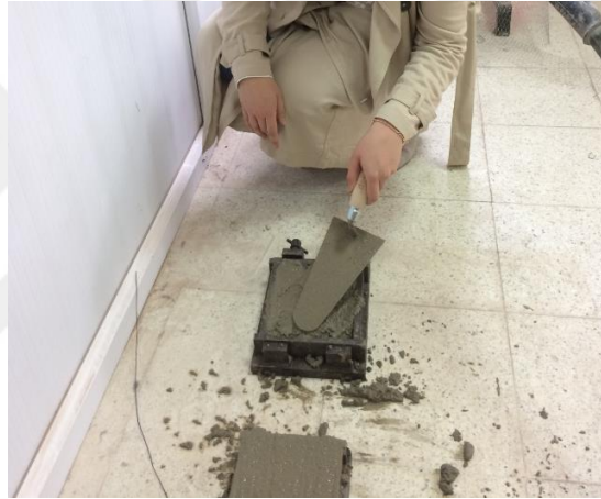
Şekil 3.16. Eğilme ve basınç testleri için çimento harcı numunelerinin hazırlanması
