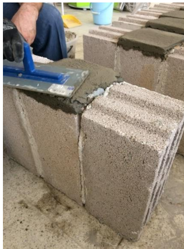
Şekil 3.10. Bims blok numunelerin boşluklu yüzeylerinin düzeltilmesi
