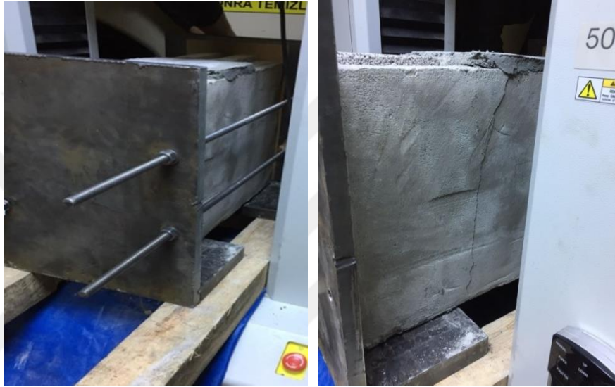
Şekil 3.85. D3R01-Y-3 kodlu numunenin deney öncesi ve sonrasında durumu
