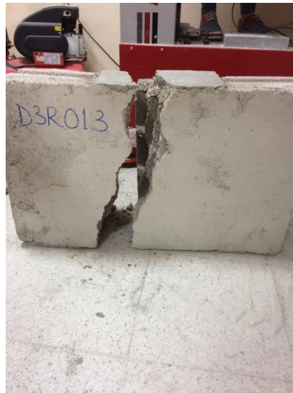
Şekil 3.33. D3R01-3 kodlu numunenin deney sonrasındaki durumu
