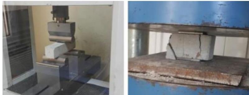
Şekil 3.17. Harç numunelerinin eğilme ve basınç testlerine tabi tutulması
