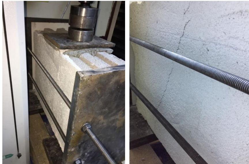
Şekil 3.100. D3T03-Y-3 kodlu numunenin deney öncesi ve sonrasındaki durumu
