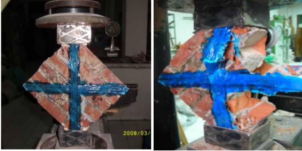
Şekil 1.19. Güçlendirilmiş numunenin yükleme öncesi ve sonrasındaki durumu [22]
