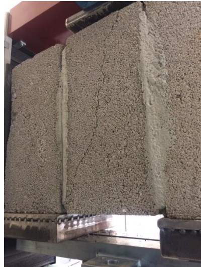
Şekil 3.37. D3S02-1 kodlu numunenin arka yüzeyinde deney sonrasında durumu
