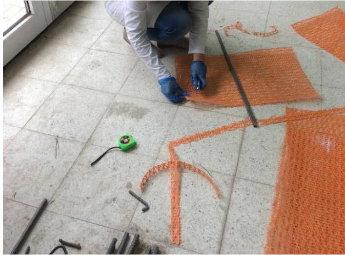
Şekil 3.7. Sismik kumaşın numune yüzeylerine uygun olarak kesilmesi
