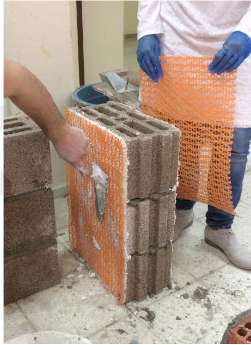
Şekil 3.8. Sismik kumaşın numunenin her iki yüzeyine uygulanması
