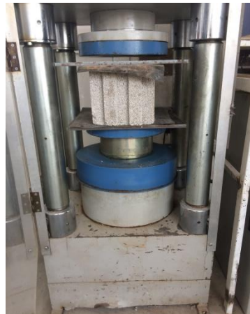
Şekil 3.18. Bims blok basınç testi
