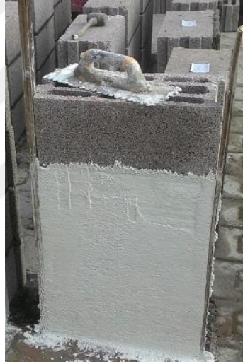
Şekil 3.5. Cam kürecik esaslı sıvanın numuneye uygulanması
