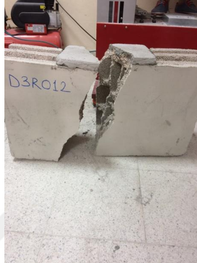
Şekil 3.30. D3R01-2 kodlu numunenin deney sonrasındaki durumu
