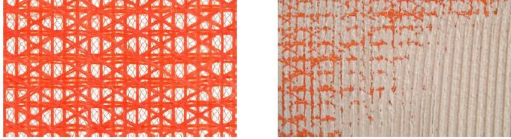
Şekil 3.6. Kompozit sismik kumaş ile özel bağlayıcı sıva
