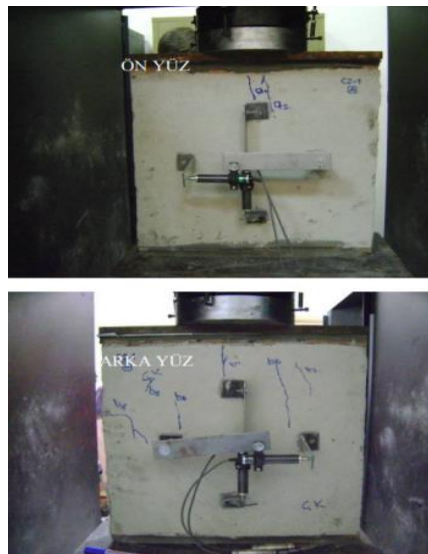
Şekil 1.20. Numunenin deney sonrası hasar durumu ve çatlak genişlikleri [25]
