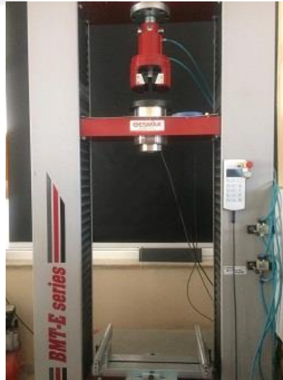
Şekil 3.11. Deney I grubundaki numuneler için kullanılan basma-çekme test cihazı
