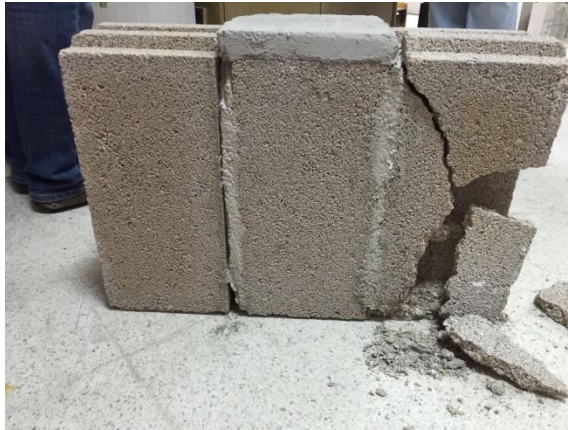
Şekil 3.60. D31G03-1 kodlu numunenin arka yüzeyinin deney sonrasındaki durumu
