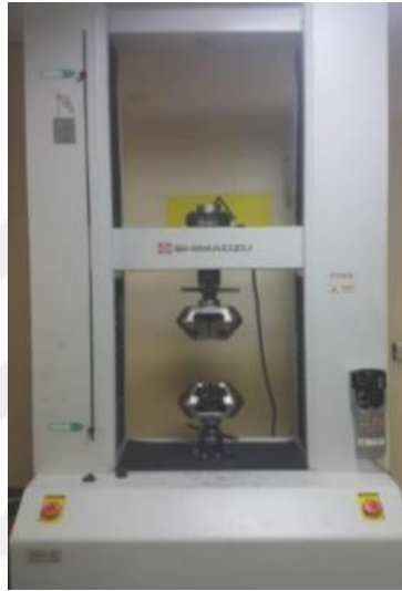
Şekil 3.13. Deney II grubundaki numuneler iin kullanılan basma-ekme test cihazı
