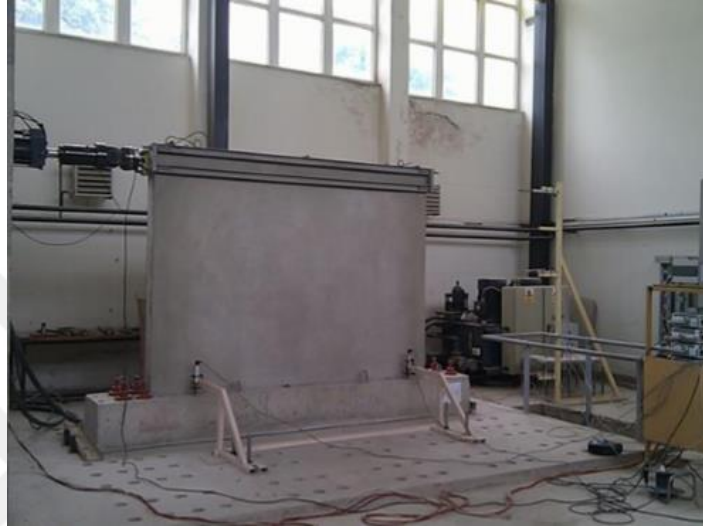
Şekil 1.24. Düzlem içi davranışı incelenen çerçevenin deney sırasındaki görünümü [34]
