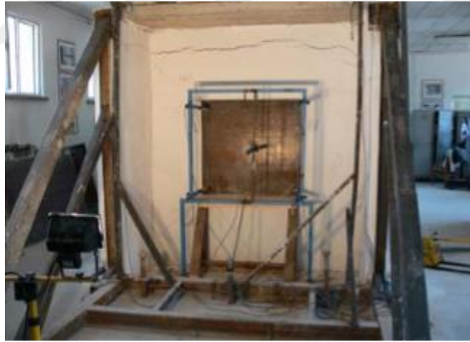
Şekil 1.18. 2 nolu numunede deney sonrasında oluşan çatlaklar [23]
