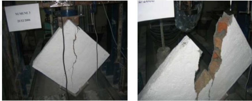
Şekil 1.21. Duvar numunesinin deney sırasındaki ve sonrasındaki durumu [26]
