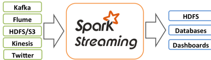
Şekil 4.5. Spark Streaming mimarisi
