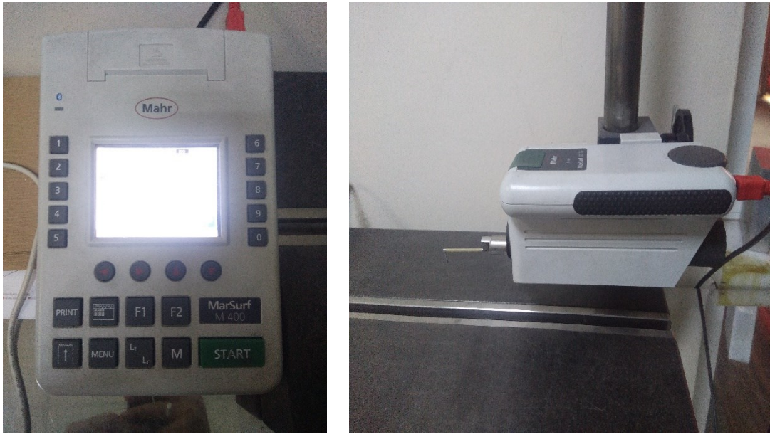
Şekil 4.5. Pürüzlülük ölçüm seti solda kontrol ünitesi MAHRSURF M400 sağda ölçüm ünitesi MAHRSURF D26
