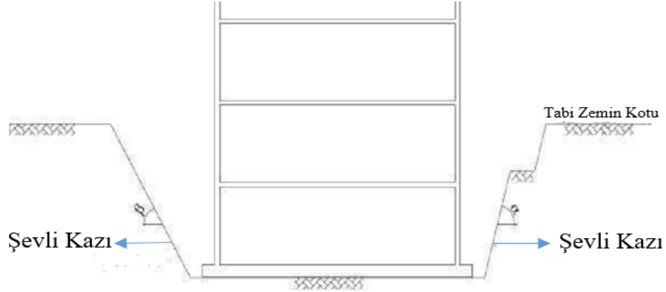
Şekil 3.1. Açık kazı (serbest şevli kazı) yöntemi [2].
