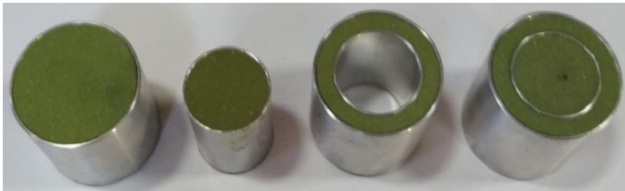
Şekil 2.7. Yüksek yoğunluklu PVC dolu alüminyum tüplerin birlikte gösterimi
