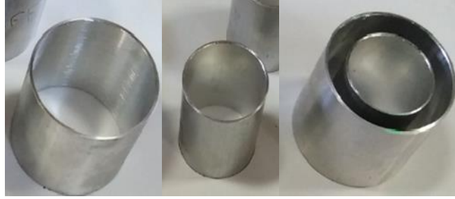
Şekil 2.5. Çapları 40 ve 58 mm alüminyum numunelerin aksel ezilme şekli
