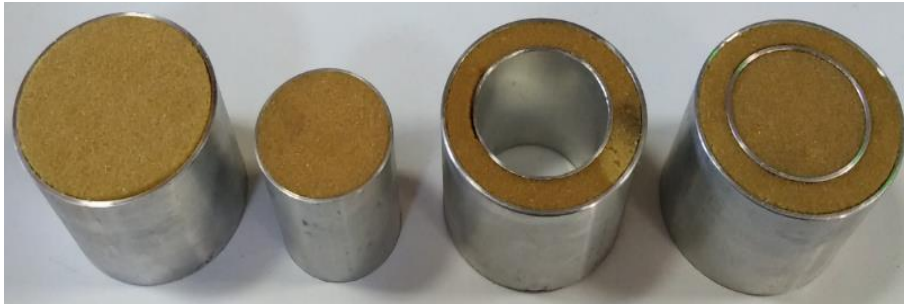
Şekil 2.6. Düşük yoğunluklu PVC dolu alüminyum tüplerin birlikte gösterimi
