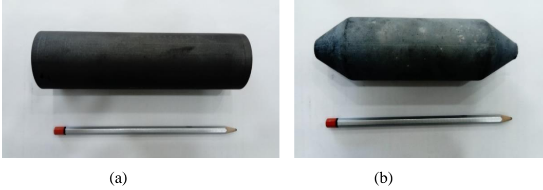
Şekil 7.4. AlN üretimi amaçlı DKTİN işlemlerinde kullanılan grafit reaktör (a) ve \text{Si}_3\text{N}_4 üretiminde kullanılan \text{Al}_2\text{O}_3 tüp (b).
