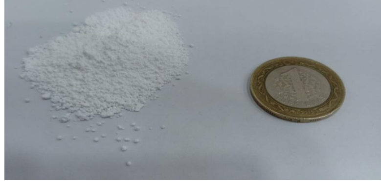
Şekil 7.6. Karbon karası kullanılmaksızın yapılan granülleme işlemiyle elde edilen silika granülleri
