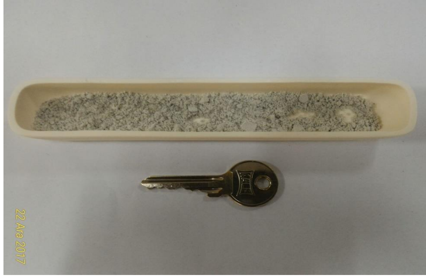
Şekil 7.9. 900°C’de 1 saat bekletilmek suretiyle yapılan karbon yakma işlemi sonrası kayıkçı içindeki \text{Si}_3\text{N}_4 numuneleri
