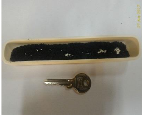
Şekil 7.8. 1450 °C’de yapılan DKTİN işlemi sonrası ve karbon yakma işlemi öncesi alümina kayıkçı içine konulmuş Si 3 N 4 esaslı reaksiyon ürünleri.
