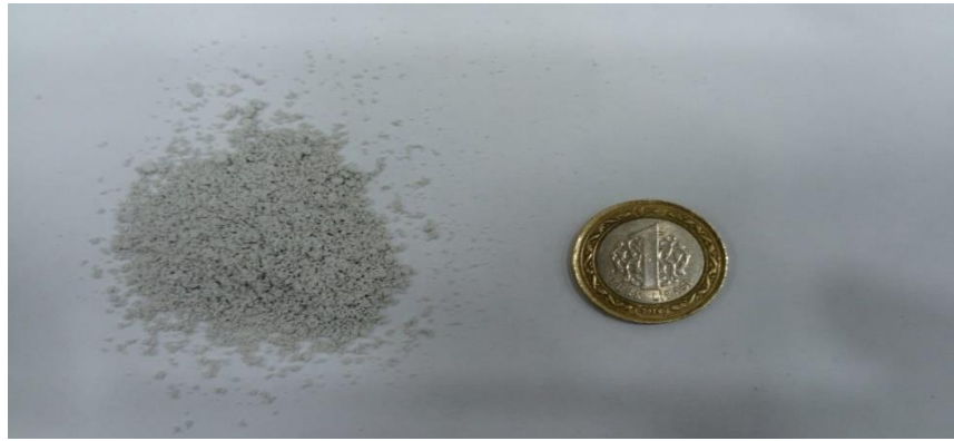
Şekil 7.10. 1450°C’de yapılan DKTİN işlemi ve nihai işlemler sonrası elde edilen \text{Si}_3\text{N}_4 tozları
