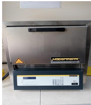
Şekil 5.6. Sinterleme işleminin gerçekleştiği Nabertherm marka fırın
