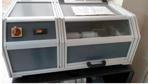
Şekil 5.2. Tozların karıştırılmasında kullanılan MSE markalı bilyalı değirmen
