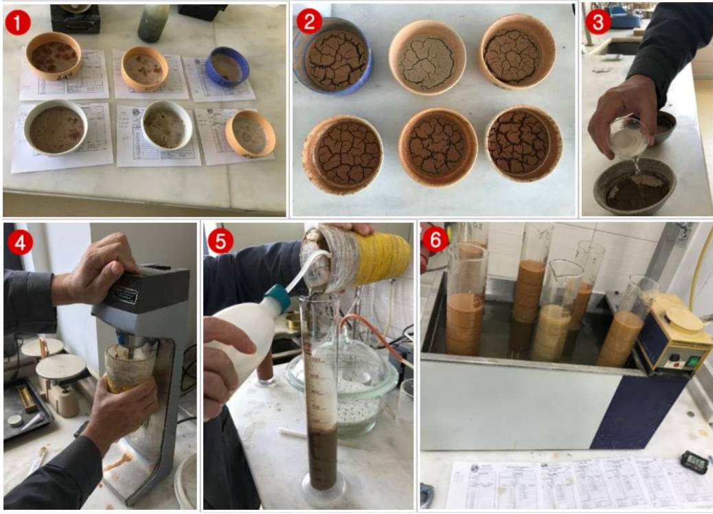
Şekil 3.8. Hidrometre deneyi yapım aşamaları.
