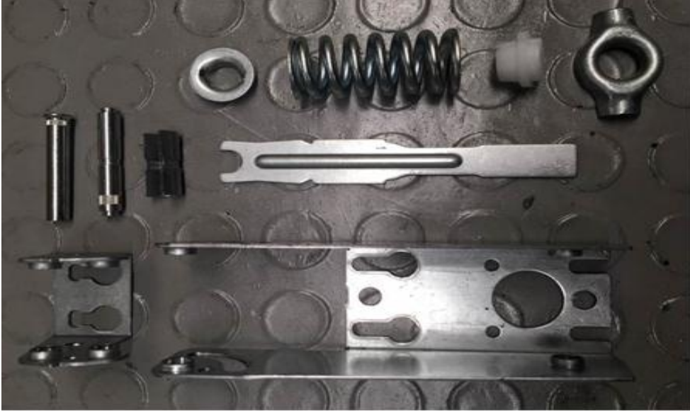
Şekil 4.10. Montajlanacak olan menteşe mekanizması parçaları
