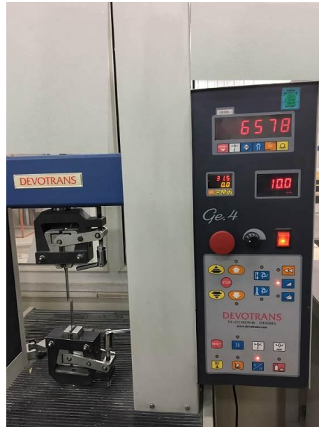
Şekil 4.2. Çekme Deneyi numunelerinin çekilmesi
