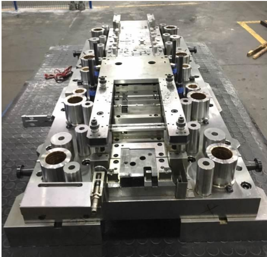
Şekil 4.7. Sac parçaların progresif kalıbı
