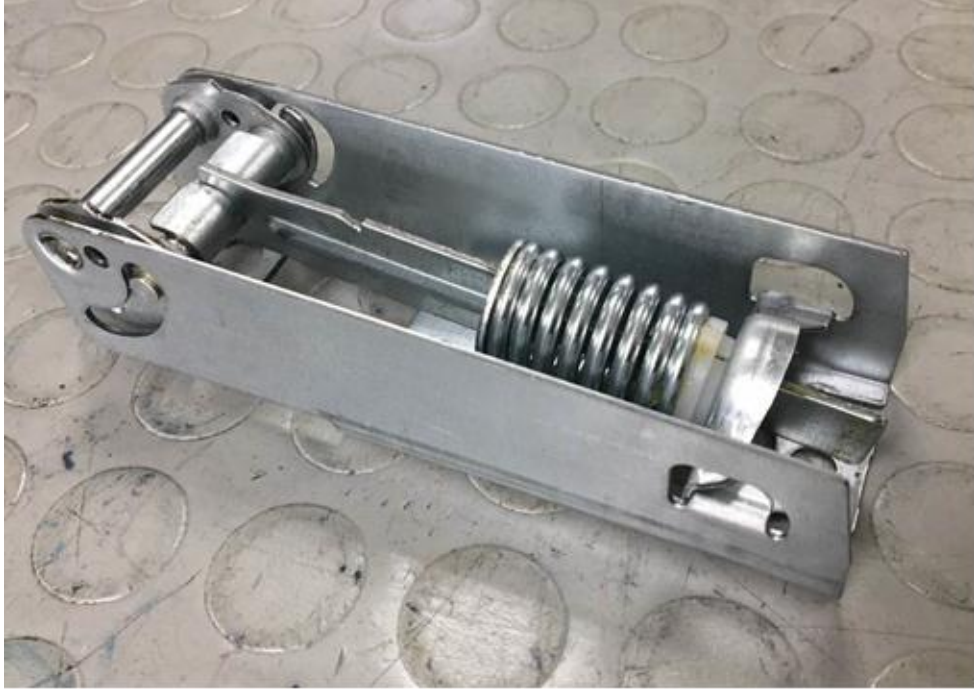
Şekil 4.12. Montajı tamamlanan menteşe mekanizması
