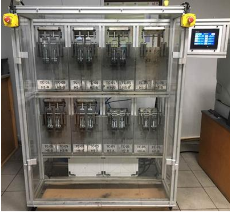
Şekil 4.14. Menteşe mekanizması test cihazı
