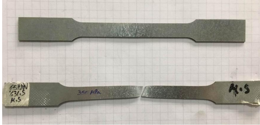
Şekil 4.1. Çekme Deneyi numuneleri (TS EN ISO 6892) (12,5 x 1,5 mm)
