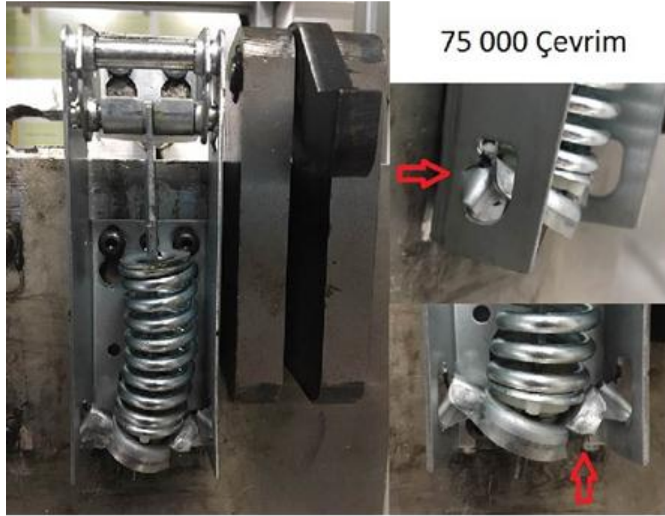
Şekil 5.1. Test sonucu olumsuz olan menteşe mekanizması
