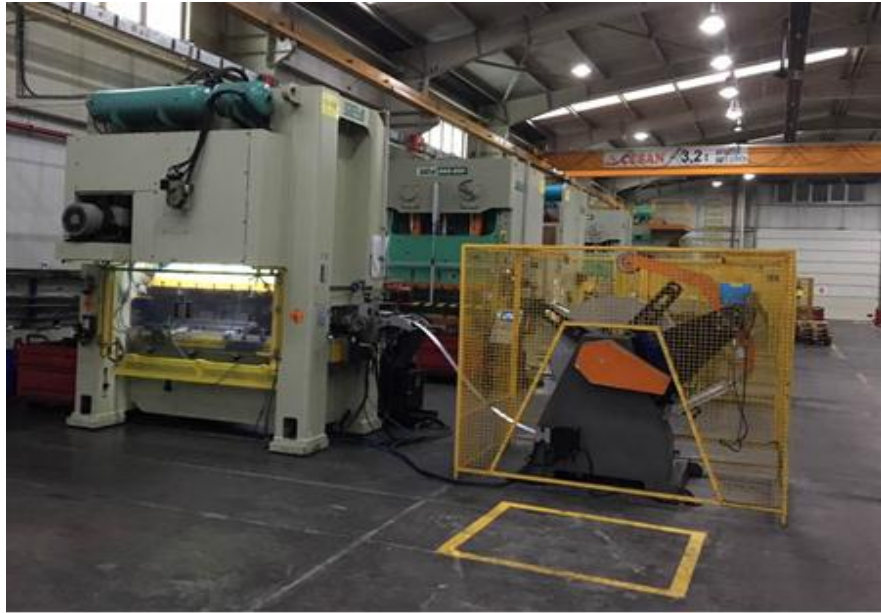
Şekil 4.9. Üretimde kullanılan eksantrik presler
