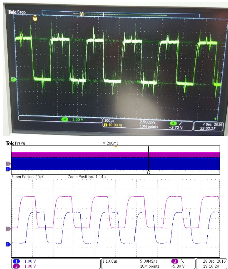
Şekil 6.3. Enkoder sinyalleri üzerindeki dv/dt değerinin etkisi (a) dv/dt = 4 \text{ kV/us} (b) dv/dt = 500 \text{ V/us}
