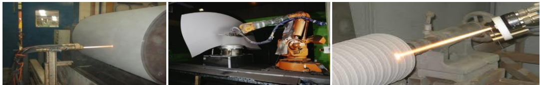
Şekil 3.7. HVOF prosesi ile kaplama uygulamalarına örnekler
