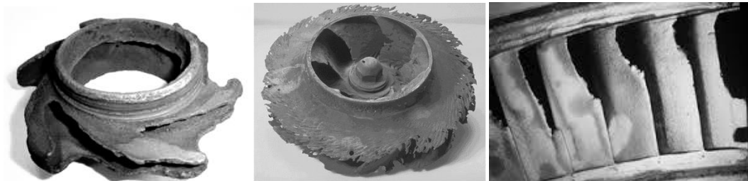
Şekil 2.2. Eroziyon aşınmaya maruz kalmış parçalar
