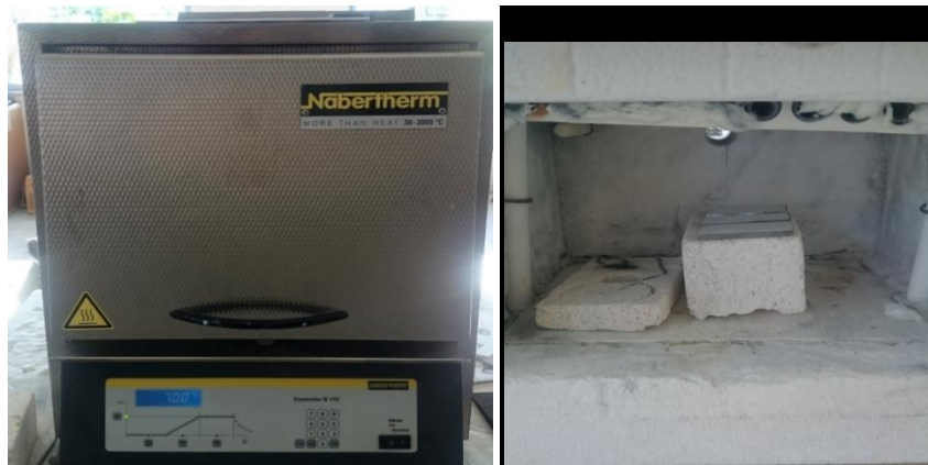
Şekil 5.3. Yüksek sıcaklık fırını ve numune yerleştirme görüntüsü
