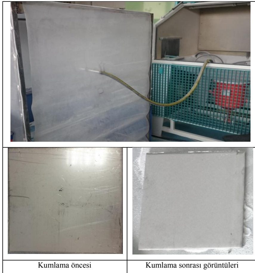
Şekil 5.1. Kumlama kabini ve kumlanmış numune görüntüsü
