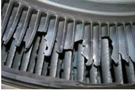
Şekil 2.4. Türbin kanatçıklarında yüksek sıcaklıklarda katı partikül erozyonu sonucu oluşan hasar
