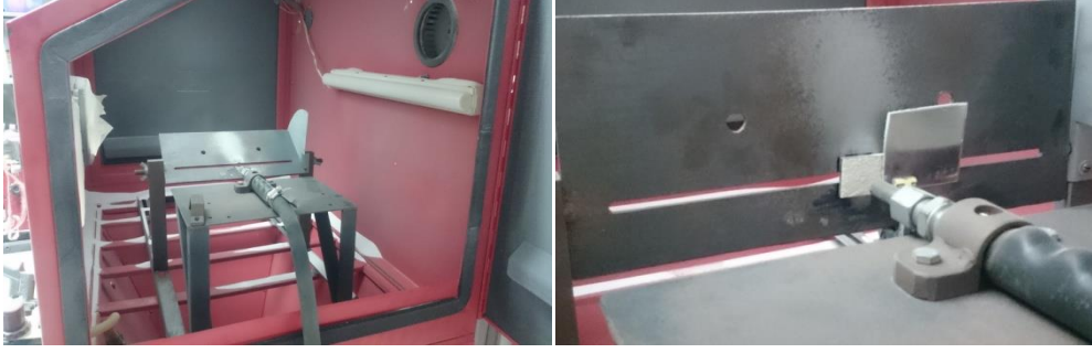
Şekil 5.10. Aşınma testi kullanılan kabin ve numune bağlama görüntüsü
