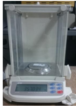
Şekil 5.9. Numuneler aşınma öncesi ve sonrası ağırlıkları hassas terazide (±0,0001gr) ölçülmüştür
