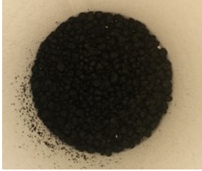
Şekil 5.8. Granülatör cihazı ile elde edilmiş granüllerin görüntüsü
