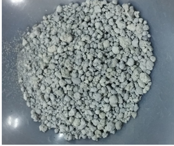
Şekil 5.9. Reaksiyon sonrası elde edilen granüller
