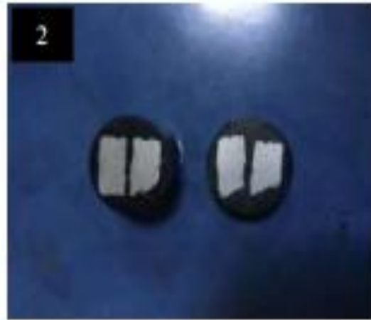
Şekil 5.12. Bakalite alınmış numune örneği (1) kusurlu yüzey, (2) düzgün yüzey
