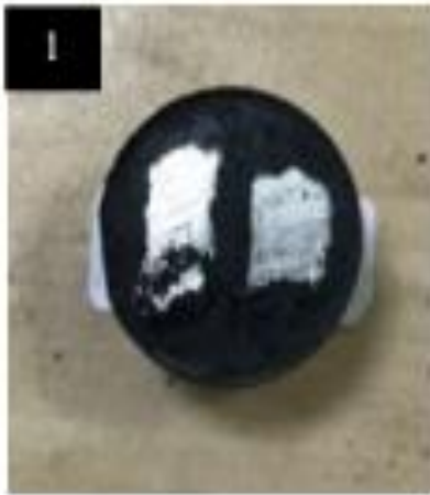
Şekil 5.12. Bakalite alınmış numune örneği (1) kusurlu yüzey, (2) düzgün yüzey
