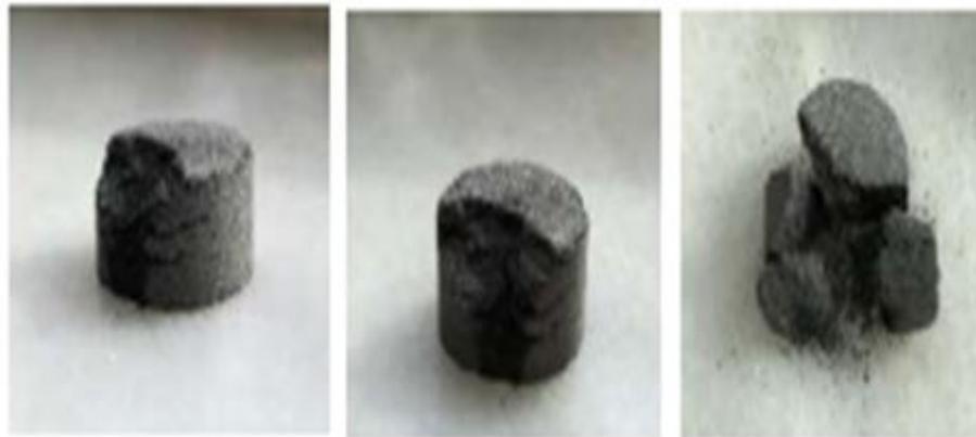
Şekil 5.10. 645°C de sinterlenmiş fakat uygun olmayan sinterleme şartları sonucu kırılmış numune örneği
