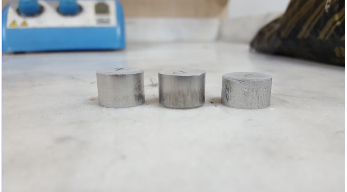
Şekil 5.8. Al 2 124-Al 2 O 3 630°C de 1 saat sinterlenmiş numune örneği
