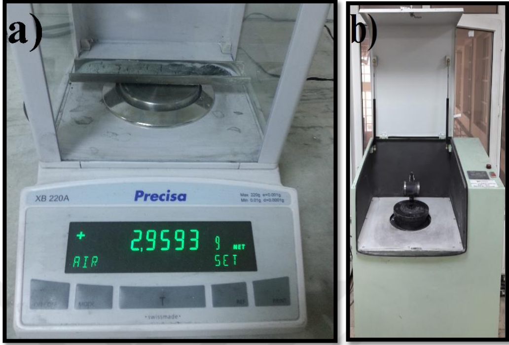
Şekil 5.2. Hassas terazide ölçüm (a) Halkalı öğütücü (b)
