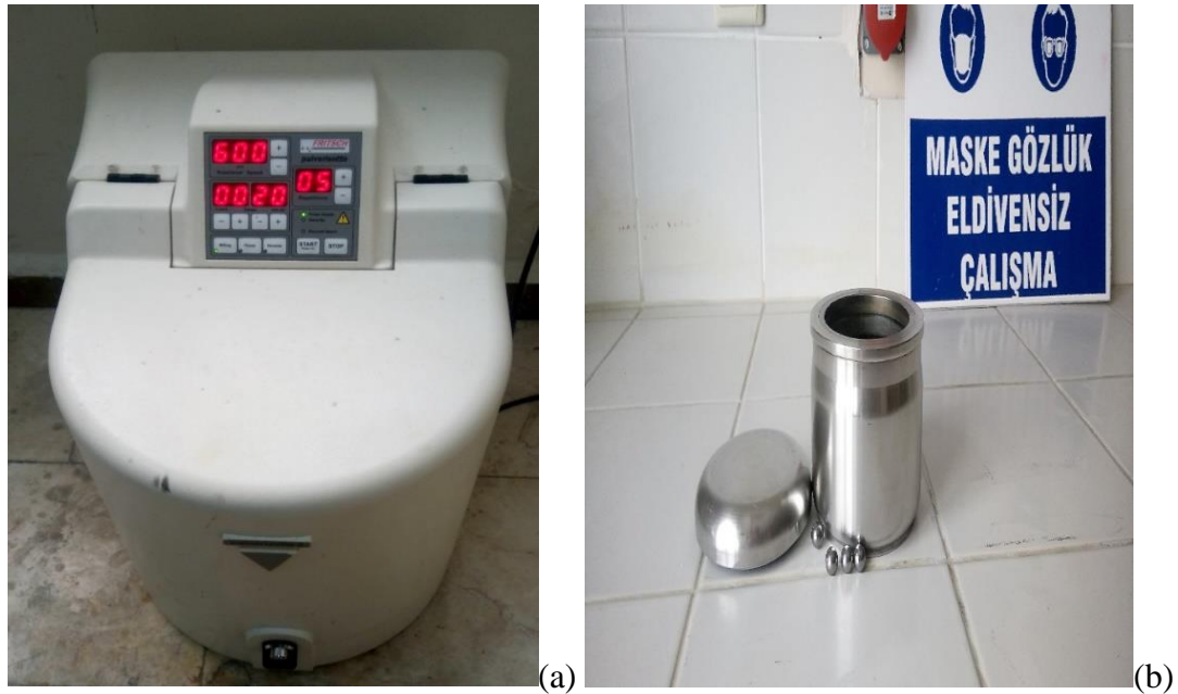
Şekil 5.3. a) Gezegensel bilyalı değirmen, b)WC'den öğütme haznesi ve bilyalar
