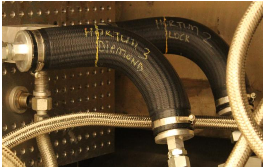
Şekil 3.11. Ömür testleri-Elmas (Diamond) örgü ile Kilit (Lock) örgü
