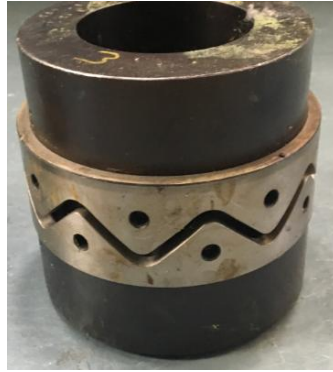
Şekil 3.2. Düz (plain) örgü oluşturmak için kullanılan kam
