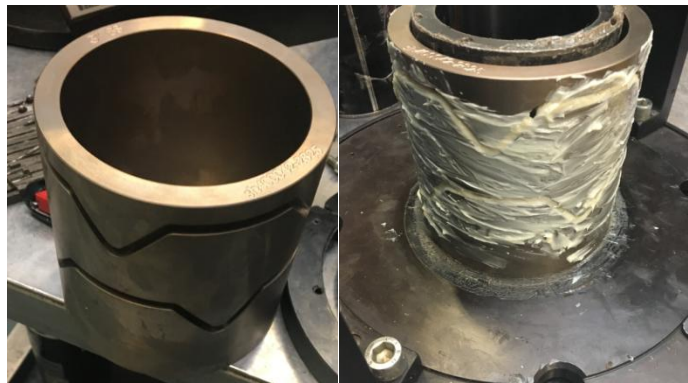
Şekil 3.8. Elmas (diamond) örgü oluşturmak için kullanılan kam
