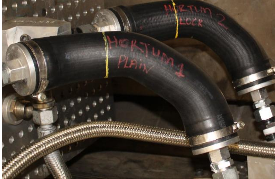
Şekil 3.10. Ömür testleri-Düz (Plain) örgü ile Kilit (Lock) örgü
