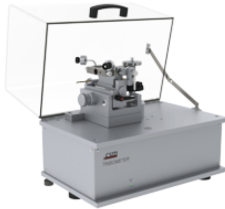
Şekil 4.4. CSM Tribometer aşınma cihazı.
