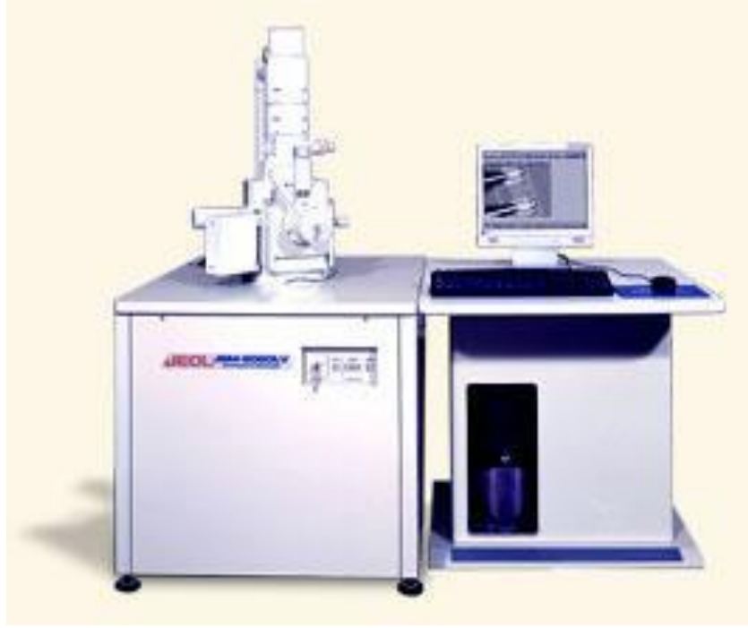
Şekil 4.7. Jeol JSM-6060 LV taramalı elektron mikroskobu.
