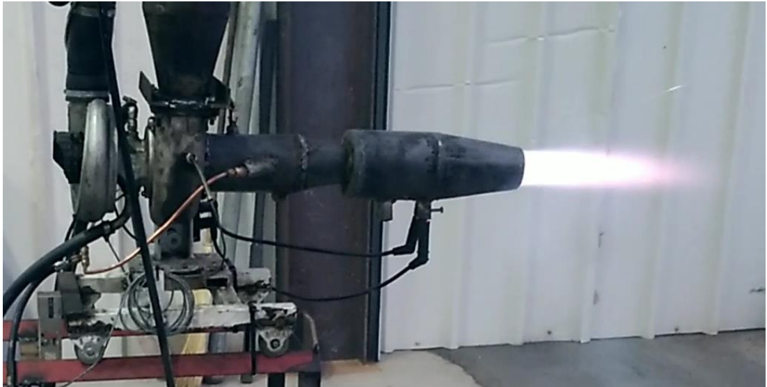
Şekil 3.22. Başarı ile çalıştırılmış ikincil yanma sistemi.
