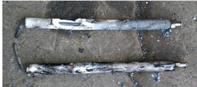
Şekil 3.13. Deneme çalışması sonrası hasar görmüş bujiler.
