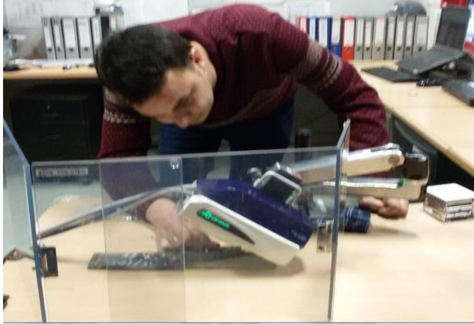
Şekil 7.24. PUSTEC u-X360s kalıntı gerilim ölçüm cihazı.
