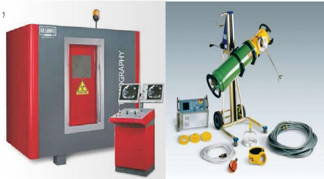
Şekil 5.12. Sabit Xray cihazı ve hareketli X ışını tüpü [13].
