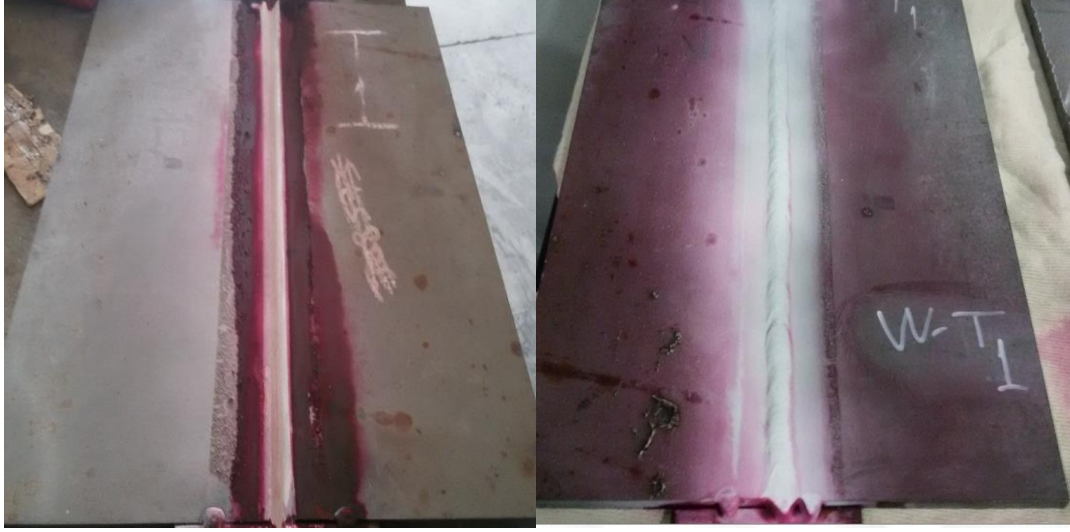
Şekil 7.7. T1 Nolu deney parçası penetrant muayenesi.
