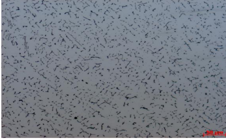
Şekil 8.22. T1 nolu numune kaynak metali kaynak kepi bölgesi 200X mikroyapı görüntüsü.
