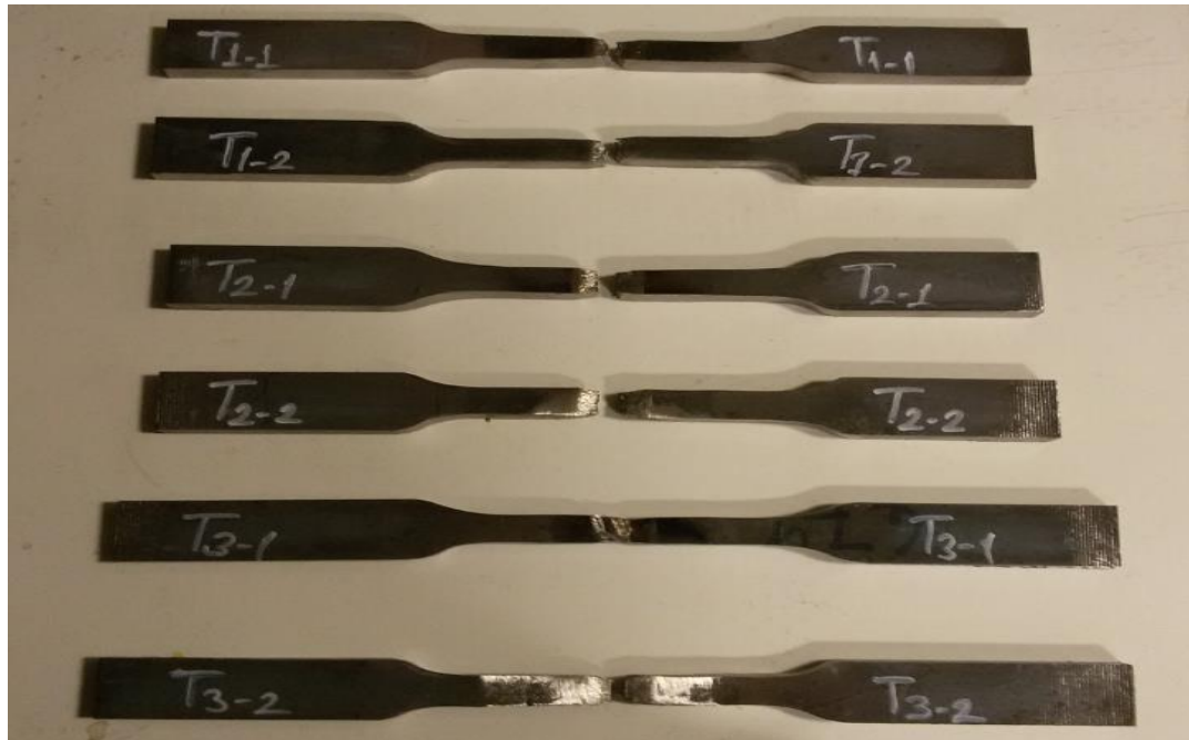
Şekil 8.5. Çekme testi sonrası numunelerin gösterimi.
