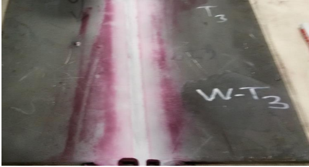
Şekil 7.9. T3 Nolu deney parçası penetrant muayenesi.
