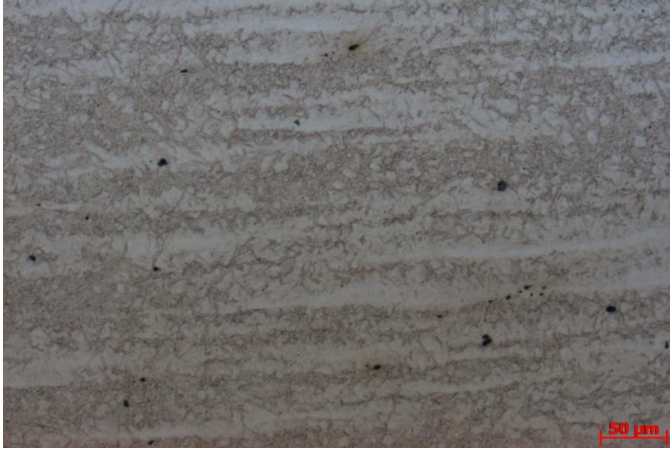
Şekil 8.36. T2 nolu numune orta haz bölgesi 200X mikroyapı görüntüsü.
