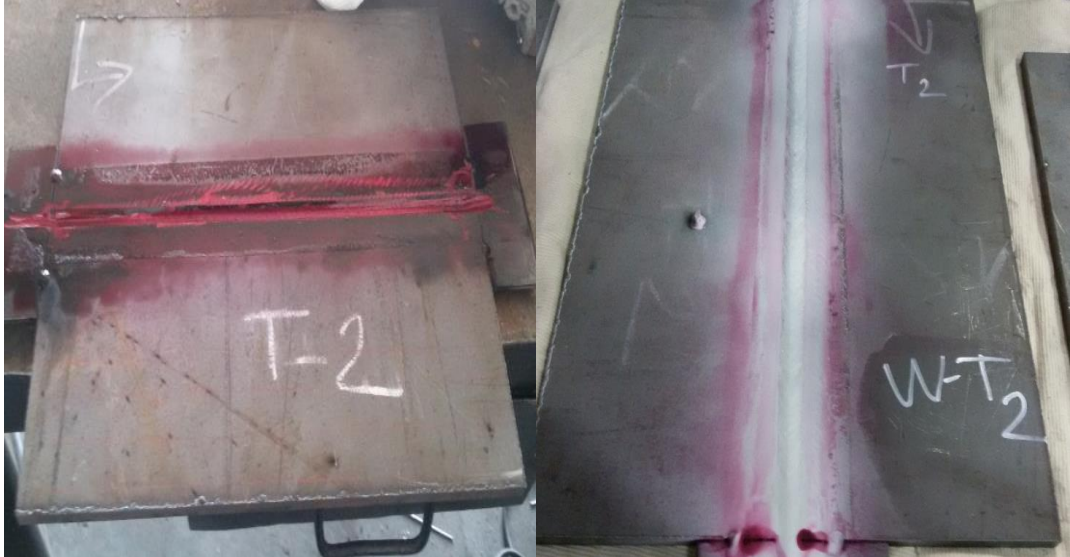
Şekil 7.8. T2 Nolu deney parçası penetrant muayenesi.
