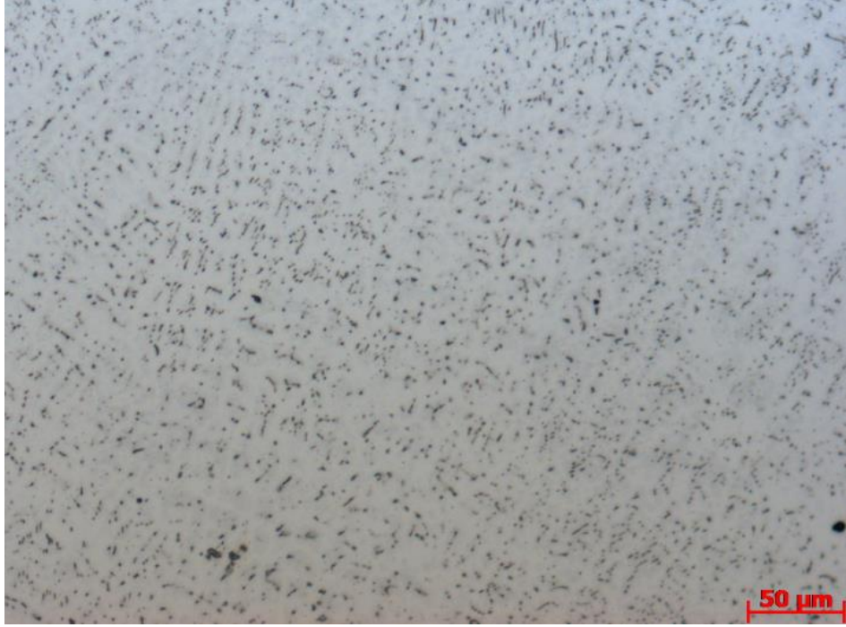
Şekil 8.40. T3 nolu numune kaynak metali kaynak kökü orta bölgesi 200X mikroyapı görüntüsü.
