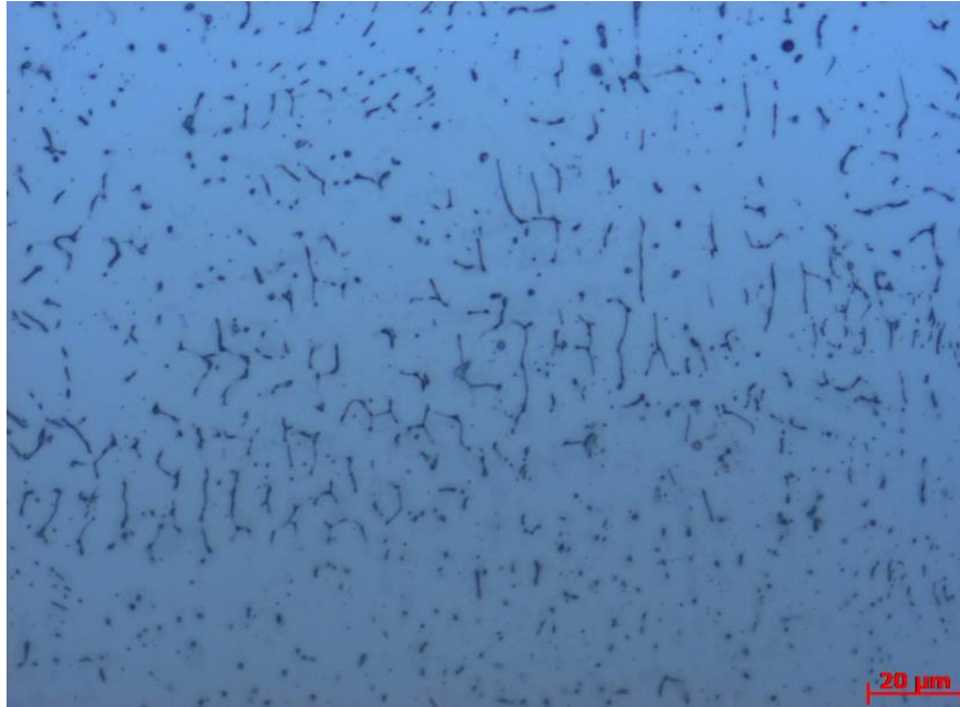
Şekil 8.25. T1 nolu numune kaynak metali kaynak kökü orta bölgesi 500X mikroyapı görüntüsü.
