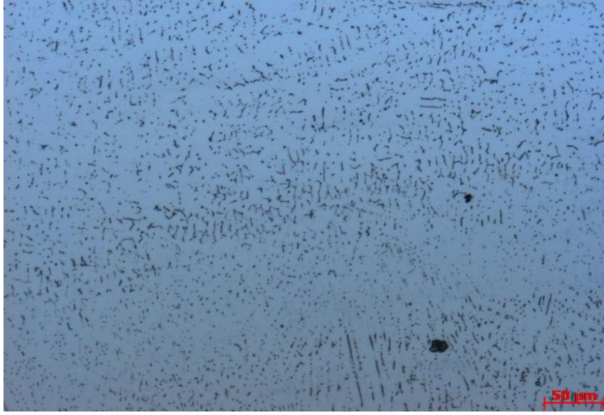
Şekil 8.24. T1 nolu numune kaynak metali kaynak kökü orta bölgesi 200X mikroyapı görüntüsü.
