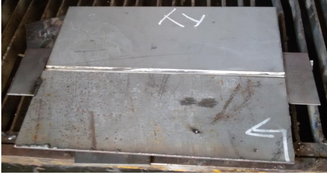
Şekil 7.1. Kaynak için hazırlanmış T1 numunesi.
