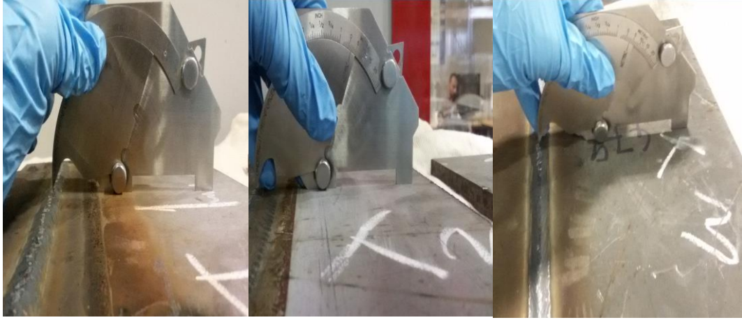
Şekil 7.5. Deney parçaları kaynak kepi ölçümü.
