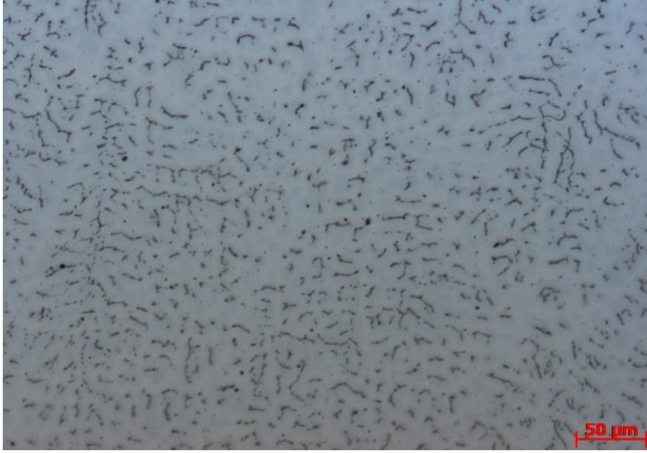
Şekil 8.38. T3 nolu numune kaynak metali kaynak kepi bölgesi 200X mikroyapı görüntüsü.
