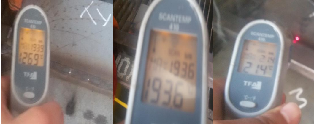
Şekil 7.4. Kaynak bitiş anında yapılan sıcaklık kontrolleri.
