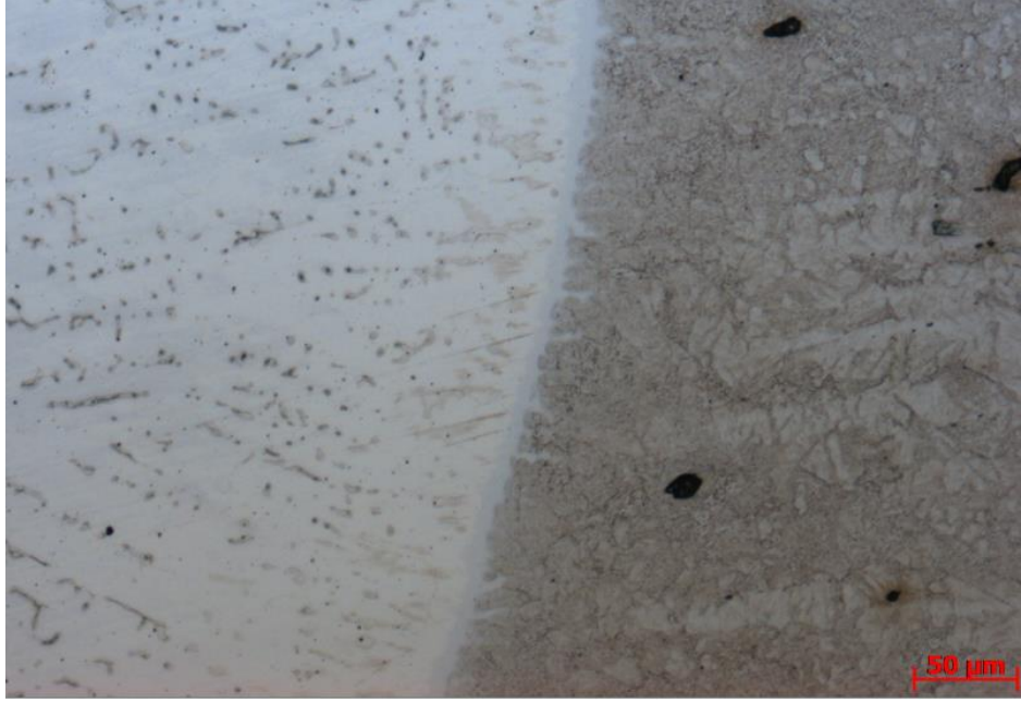
Şekil 8.34. T2 nolu numune kaynak orta kök-haz geçiş bölgesi 200X mikroyapı görüntüsü.
