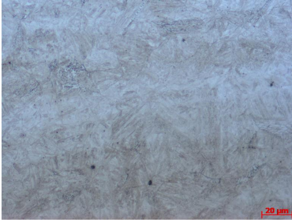
Şekil 8.45. T3 nolu numune orta haz bölgesi 500X mikroyapı görüntüsü.
