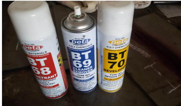
Şekil 7.6. Uygulanan penetrant sıvısı, temizleyici ve geliştirici.
