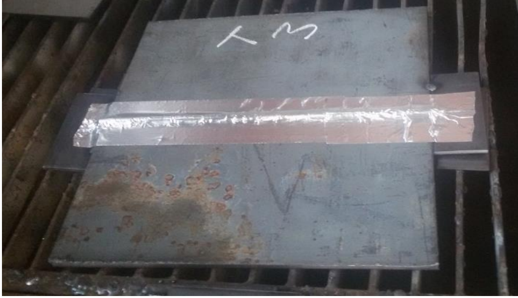
Şekil 7.3. Kaynak için hazırlanmış T3 numunesi.
