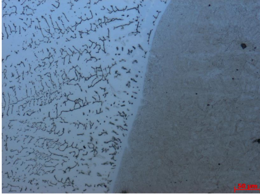
Şekil 8.26. T1 nolu numune kaynak orta kök-haz geçiş bölgesi 200X mikroyapı görüntüsü.
