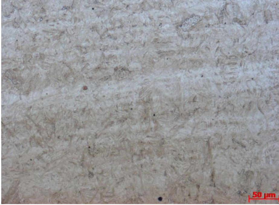
Şekil 8.44. T3 nolu numune orta haz bölgesi 200X mikroyapı görüntüsü.
