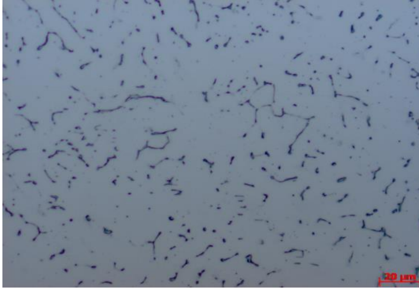
Şekil 8.23. T1 nolu numune kaynak metali kaynak kepi bölgesi 500X mikroyapı görüntüsü.
