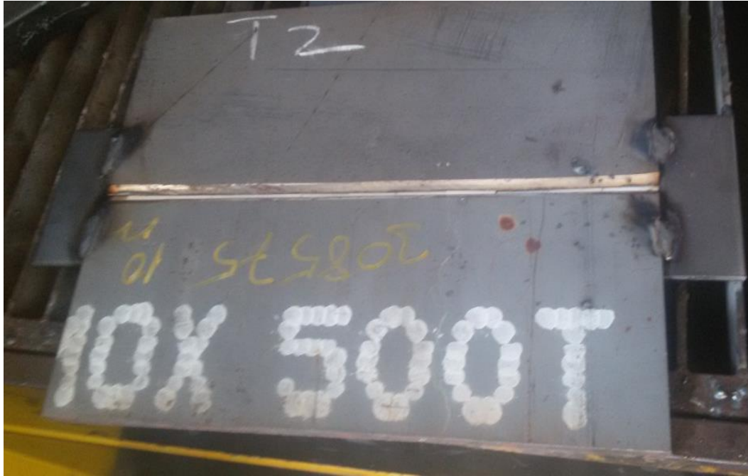
Şekil 7.2. Kaynak için hazırlanmış T2 numunesi.
