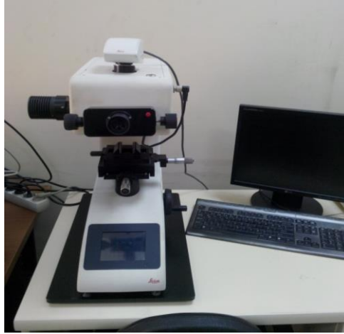
Şekil 5.1. Sertlik ölçümlerinin yapıldığı mikro sertlik cihazı.
