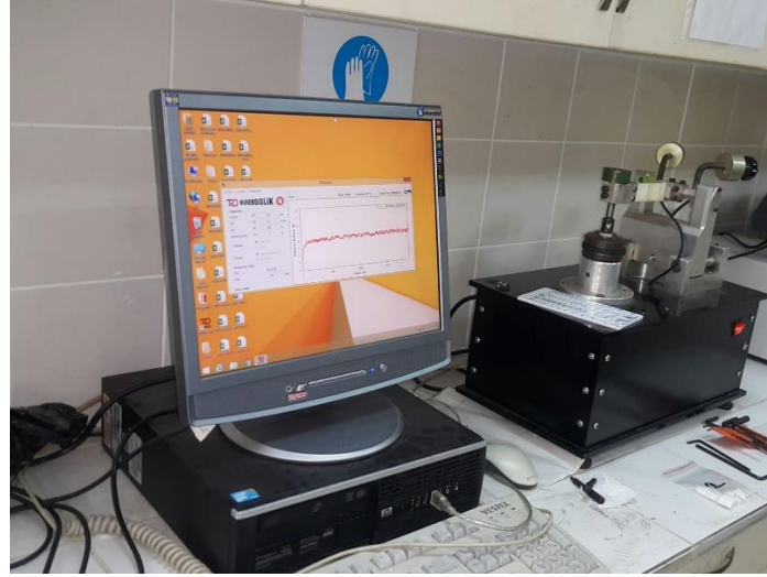
Şekil 5.2. ASTM G133 standardına uygun aşınma cihazı.
