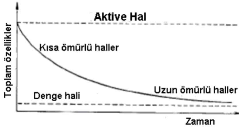
Şekil 4.2. Mekanik aktive haline genelleştirilmiş gevşeme eğrisi (Balaz P., 2000).
