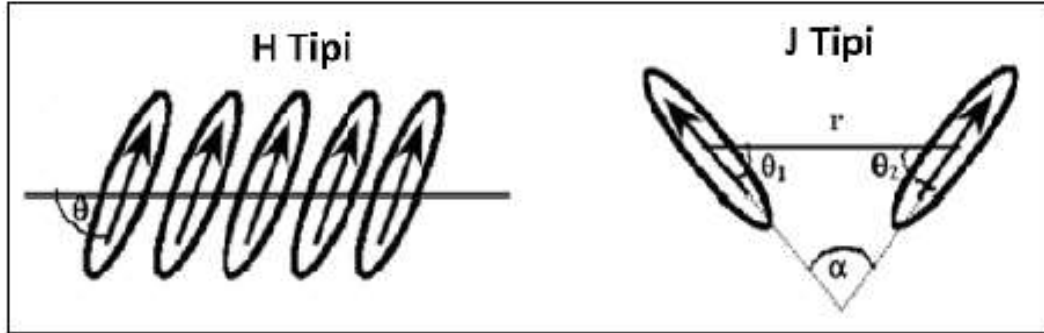
Şekil 2.7. Ftalosiyenlerde olası agregasyon tipleri
